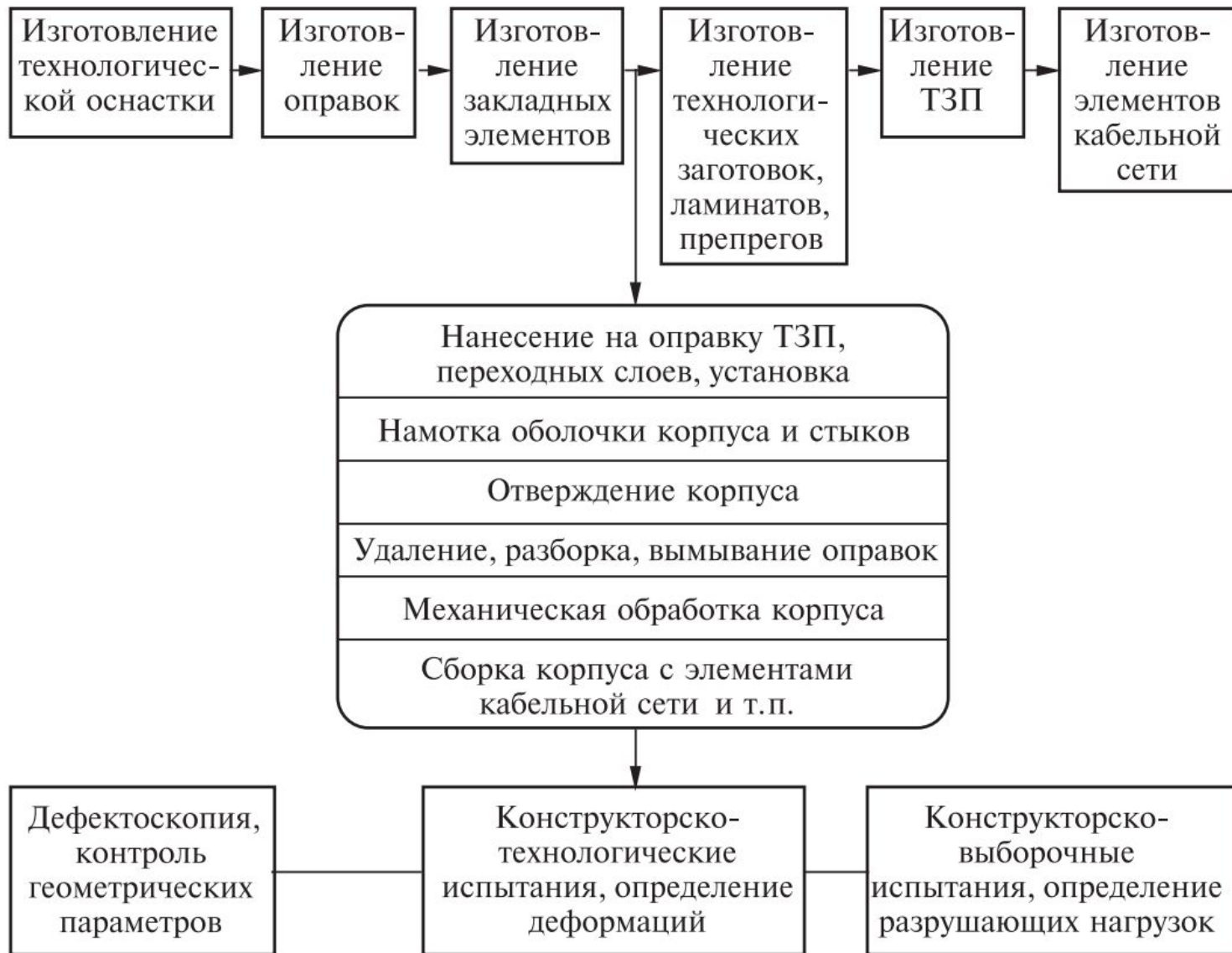
Рис. 3.1. Схема технологического процесса изготовления корпуса РДТТ.
