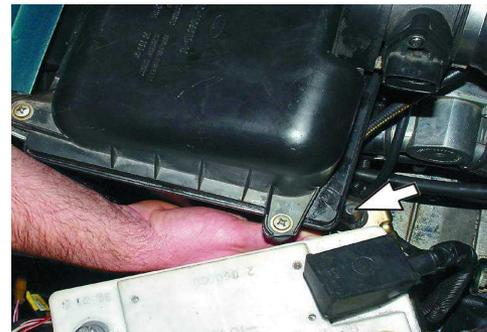
5. Снимите фильтр с автомобиля, отсоединив шланг впускной трубы от корпуса фильтра
