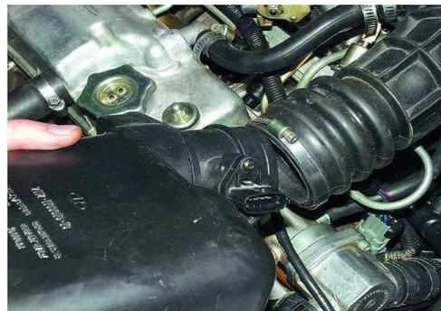
6. Установите фильтр в порядке, обратном снятию (для удобства можно снять аккумуляторную батарею). Резиновые опоры зафиксируйте в отверстиях, расправив их кромки с помощью отвертки
