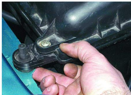
4. Приподняв переднюю часть фильтра, выдавите из отверстия кронштейна заднюю опору фильтра.
