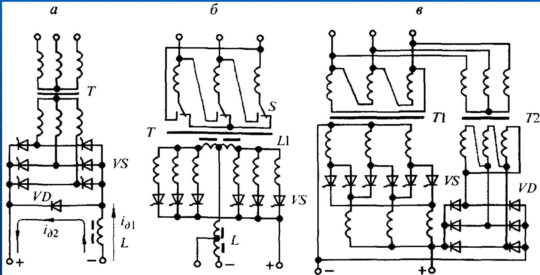
*a* — с трехфазной мостовой, *б* — с шестифазной с уравнивательным дросселем, *в* — с кольцевой схемой выпрямления
