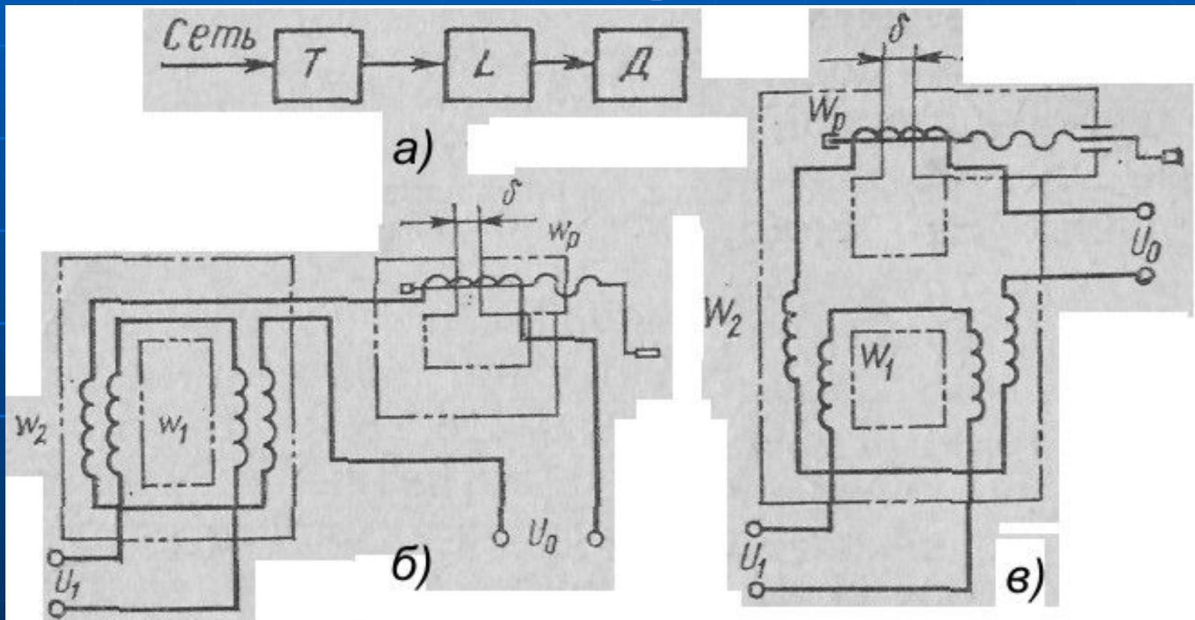
а — функциональная схема; б — электромагнитная схема трансформаторов с совмещенной реактивной катушкой; в — то же, с отдельной реактивной катушкой и воздушным зазором
