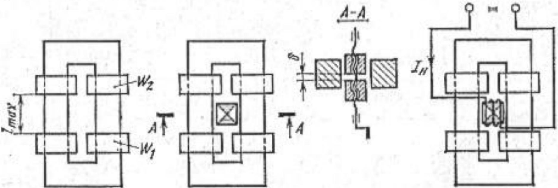
а — с раздвижными катушками типа ТД; б — с подвижными шунтами типа СТШ; в — с подмагничиваемыми шунтами типа ТДФ
