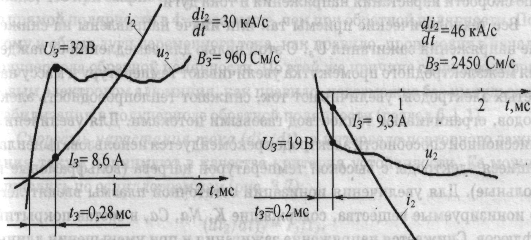
Начальные участки осциллограмм напряжения и тока дуги (электрод ОЗС-4, 3 мм, 100 А, трансформатор ТДМ-401)
