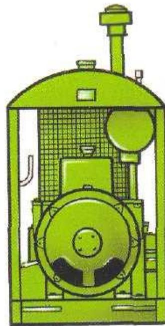
Преобразует механическую энергию двигателя внутреннего сгорания (бензинового или дизельного) в электрическую напряжением и диапазоном токов, необходимыми для сварки
