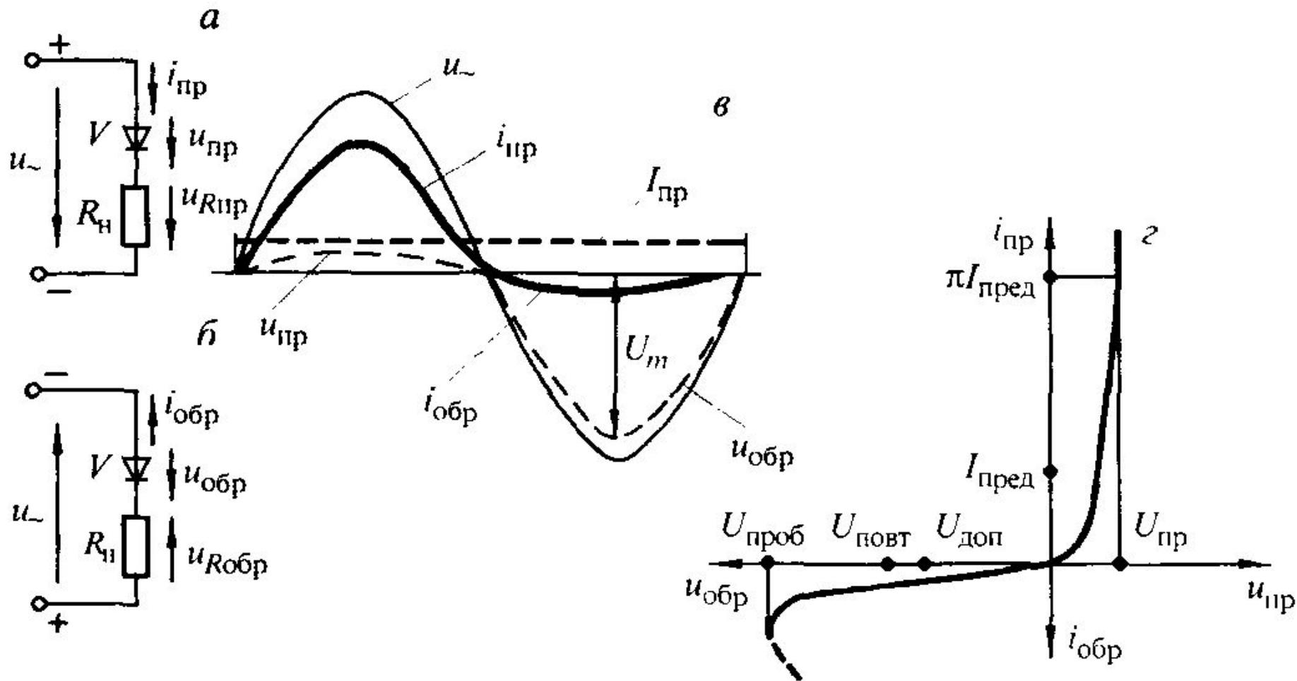
а — прямое включение, б — обратное включение, в — осциллограммы тока и напряжения, г — динамическая вольт-амперная характеристика
