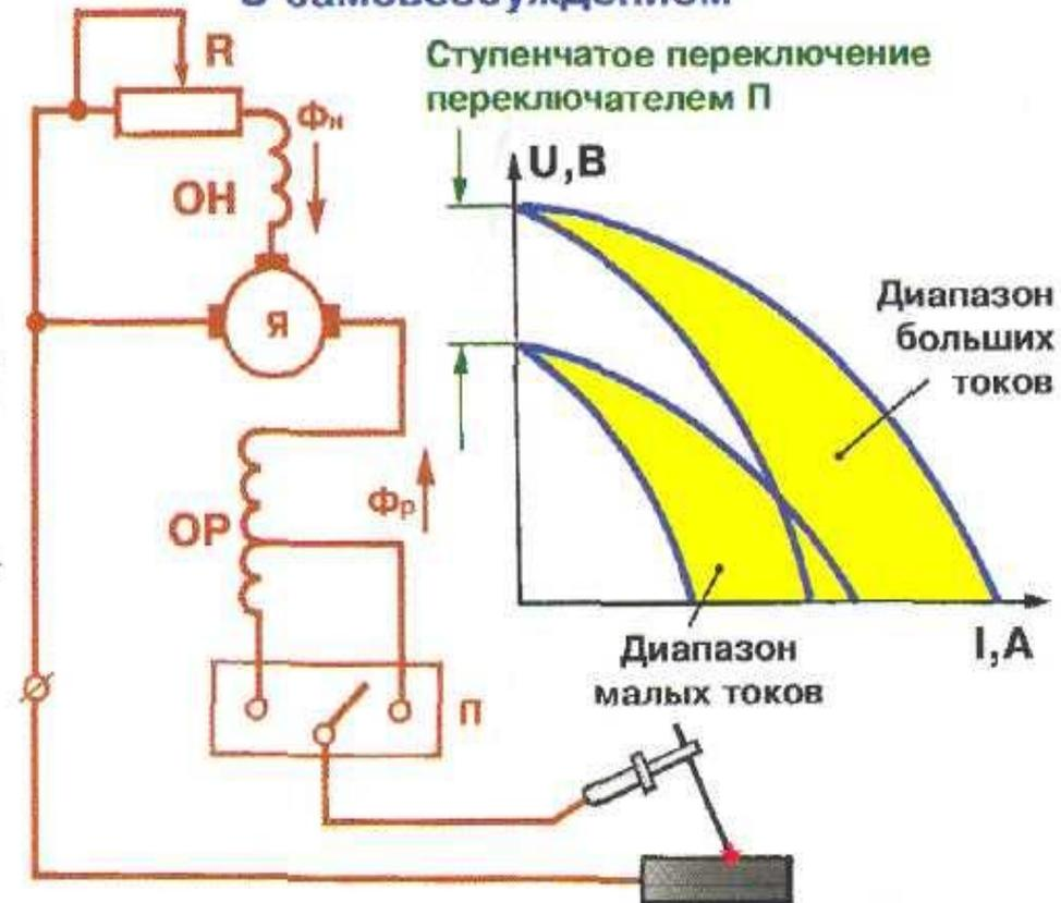
Φ<sub>н</sub> - магнитный поток намагничивающей обмотки
