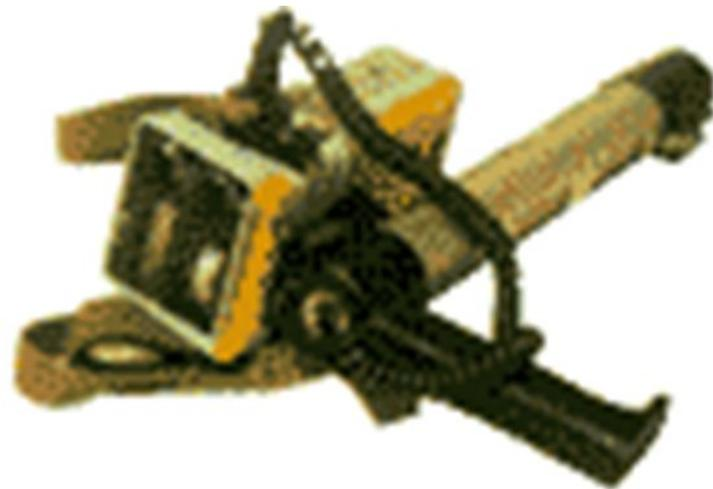
Это - профессиональный радиометр СРП-88, предназначенный для поиска и обнаружения источников гамма-излучения (например, при обследовании металлолома).
