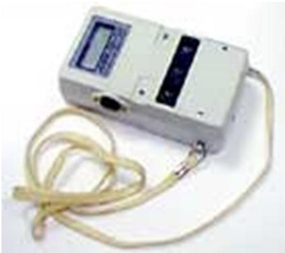
Это - распространенный бытовой дозиметр-радиометр гамма- и бета-излучения АНРИ-01-02 "Сосна".
