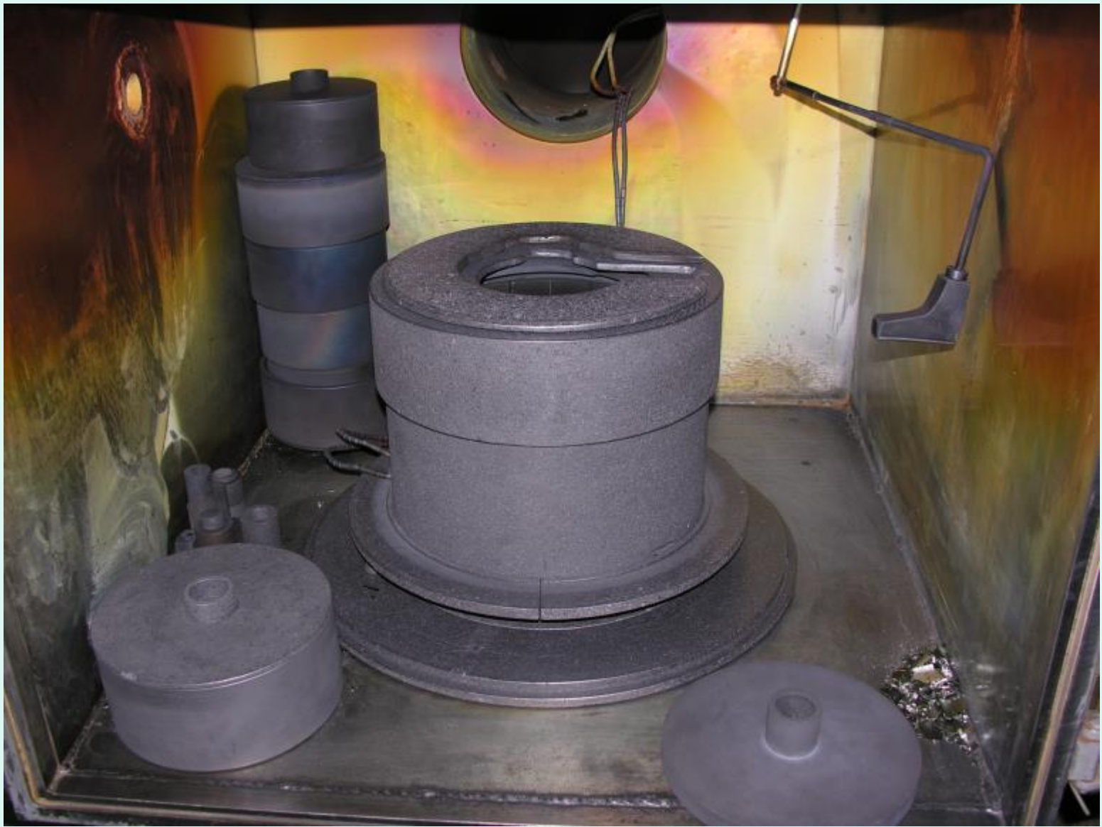
Ростовая камера с тепловым узлом из графита
