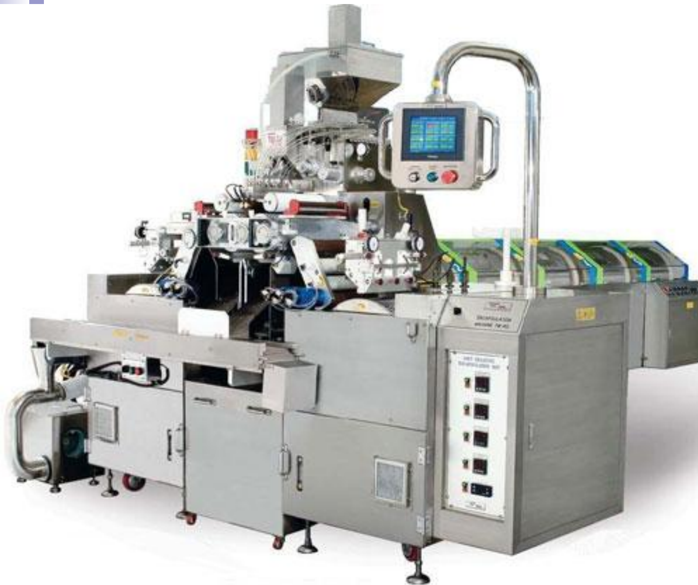
Комплексная линия производства мягких желатиновых капсул
