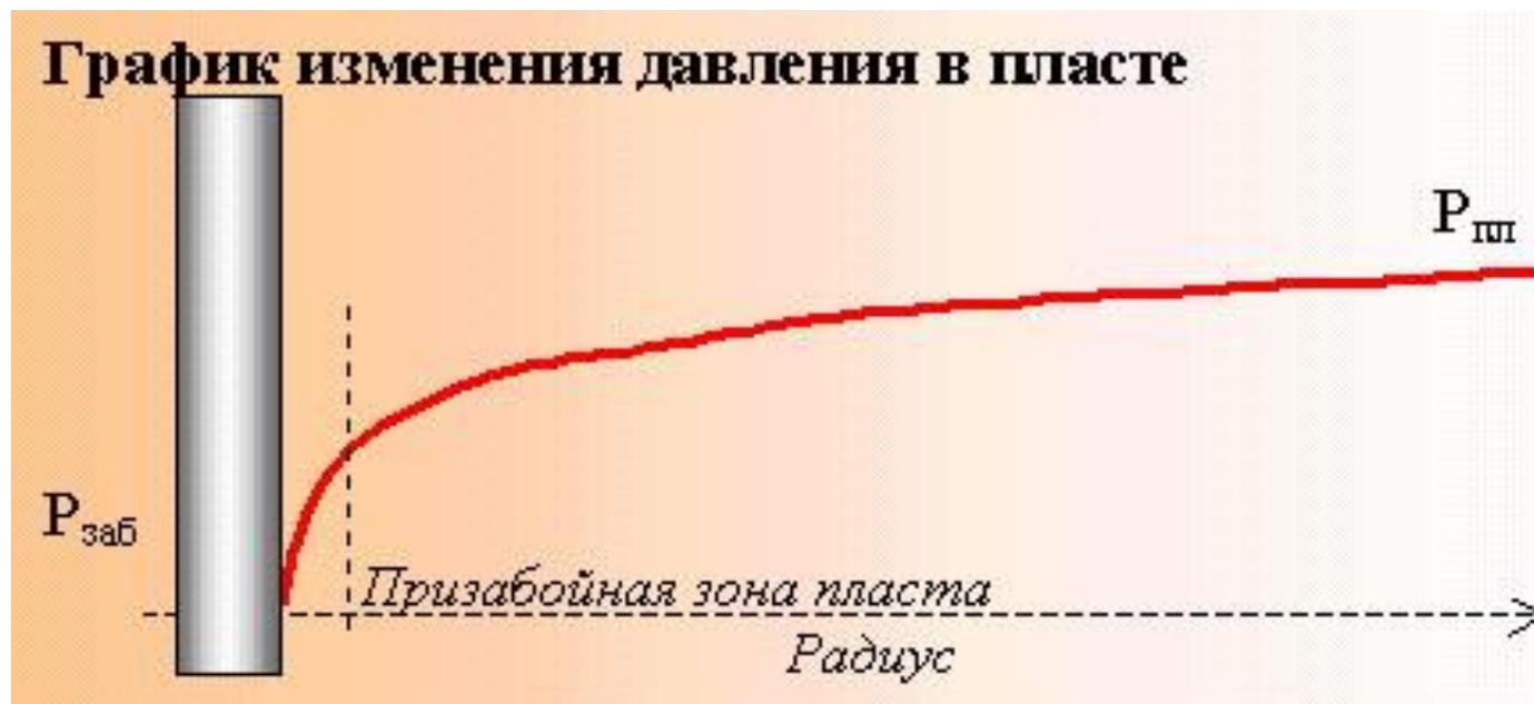
графиком зависимости  $P(r)$  является логарифмическая кривая, вращение которой вокруг оси скважины образует поверхность, называемую воронкой депрессии.
