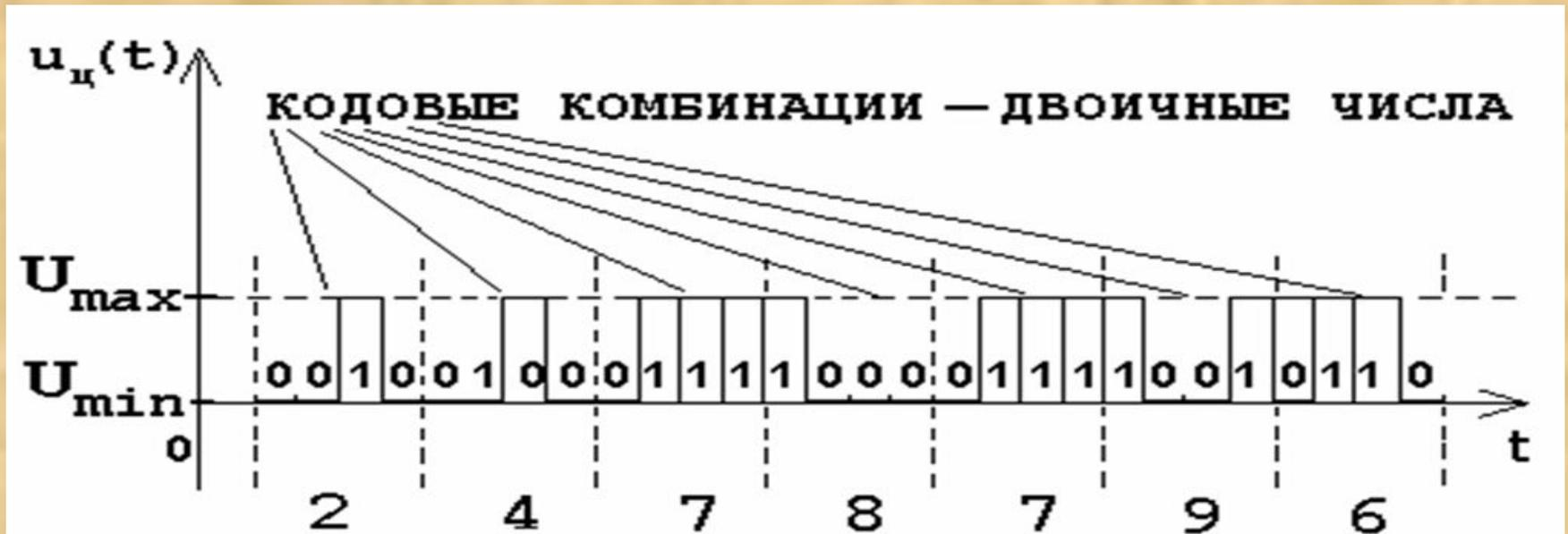
Рис. 1.10. Пример цифрового сигнала
