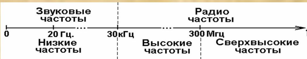
Рис.1.3. Диапазоны частот
