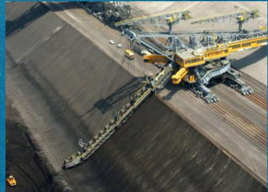
Рис. 5.4. Схема работы цепного экскаватора во фронтальном забое
