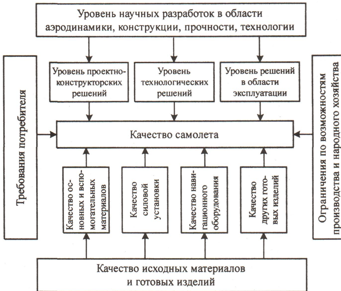
Схема формирования качества самолета
