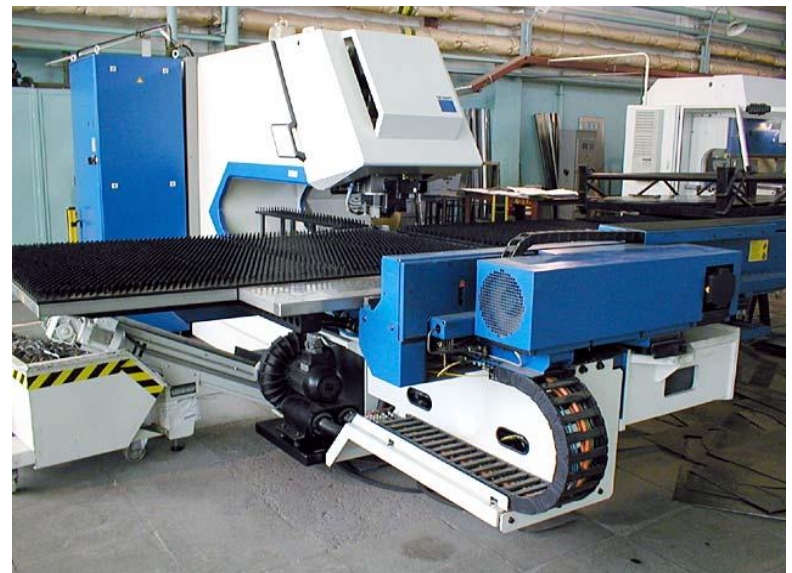
Станок «TRUMATIC 2000-R» для вырубki, высечки и пластического формообразования
