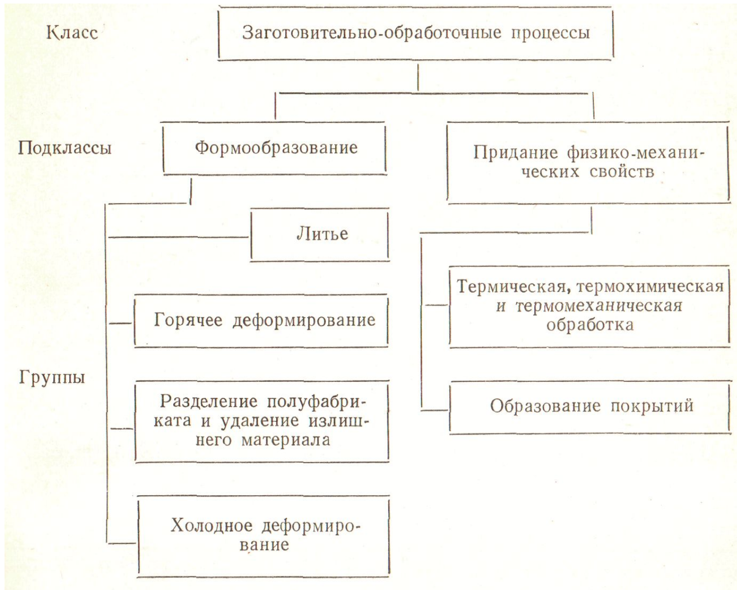
Рис.9.1. Классификация заготовительно-обработочных технологических процессов
