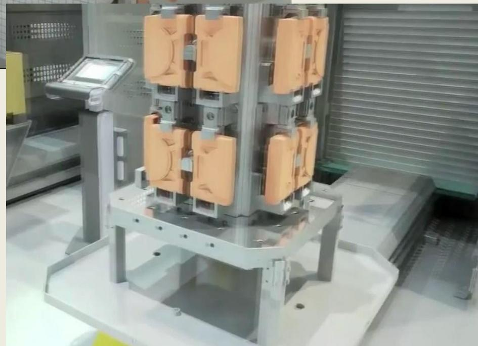
□ **автоматизированная система инструментального обеспечения (АСИО)** - система взаимосвязанных элементов, включающая участки подготовки инструментов, их транспортирования, накопления, устройства смены и контроля качества инструмента, обеспечивающие подготовку, хранение, автоматическую установку и замену инструмента;
