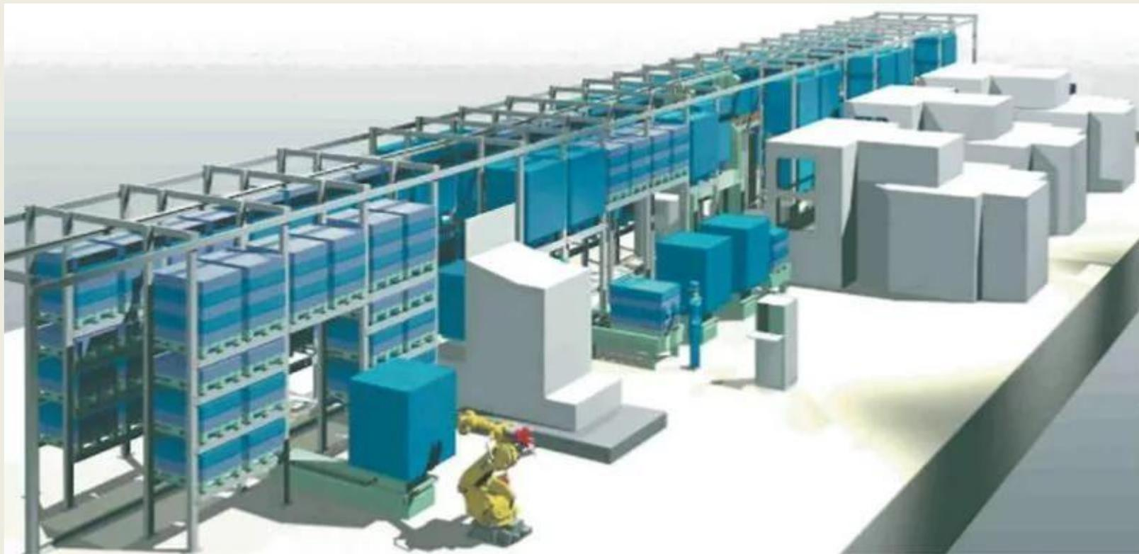
**Третий уровень** — **гибкий автоматизированный участок (ГАУ)**. Это гибкая производственная система, состоящая из **нескольких гибких производственных модулей, объединенных АСУ, функционирующая по технологическому маршруту** и предусматривающая **возможность изменения последовательности использования технологического оборудования**.
