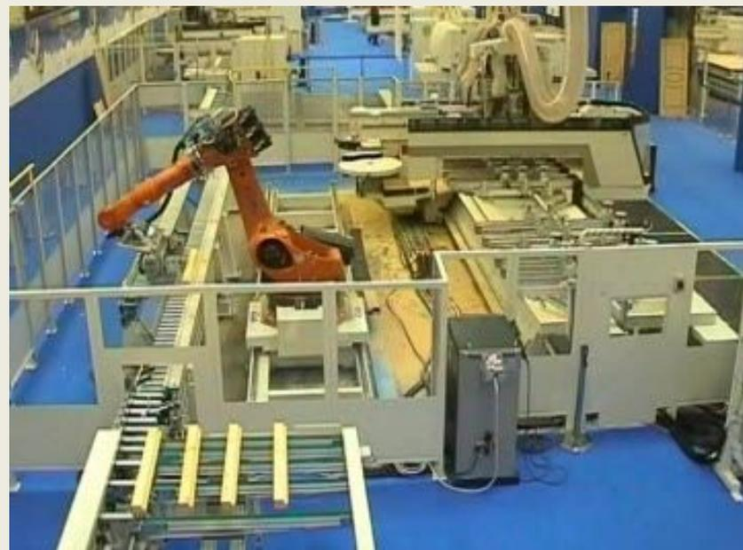
**Второй уровень** — гибкая автоматизированная линия (ГАЛ). Это гибкая производственная система, состоящая из нескольких гибких производственных модулей, объединенных автоматизированной системой управления.
