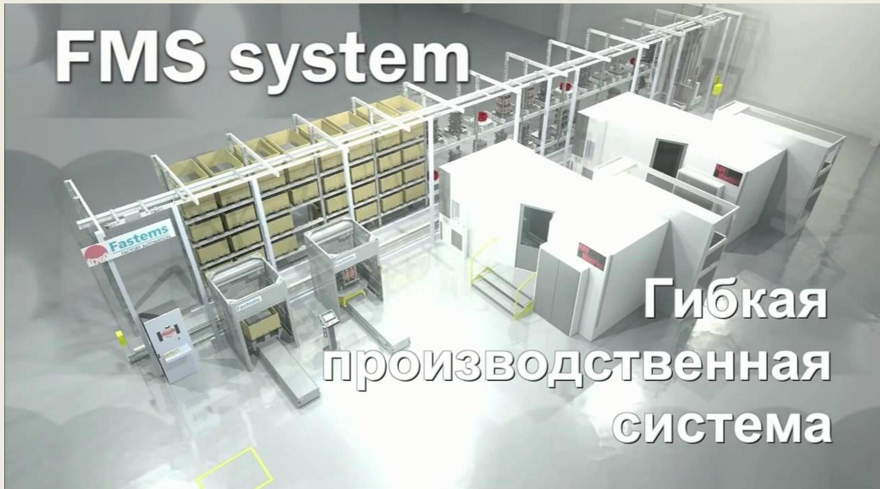
**Гибкая производственная система (ГПС)** — отдельная единица технологического оборудования или совокупность таких единиц, а также систем обеспечения их функционирования в автоматическом режиме.
