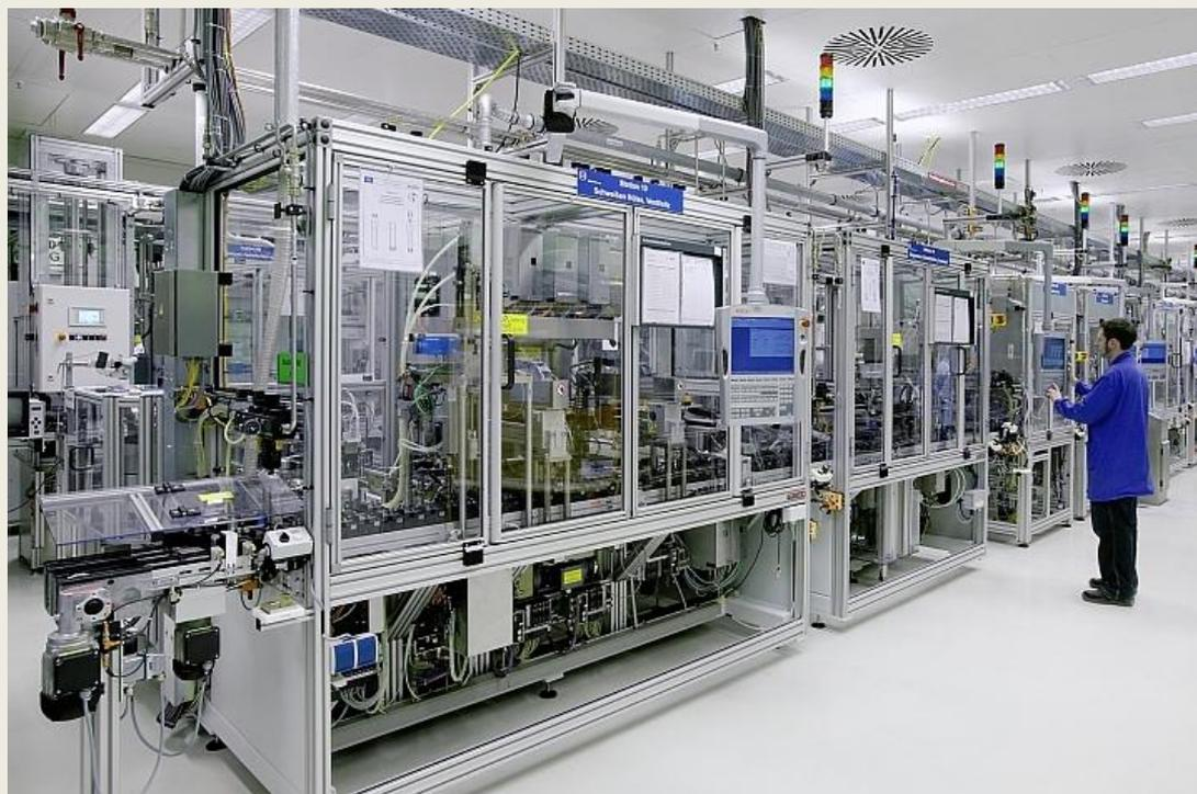
**Четвертый уровень** — **гибкий автоматизированный цех (ГАЦ)**. Это гибкая производственная система в виде **совокупности гибких автоматизированных линий или участков**, предназначенная для изготовления изделий заданной номенклатуры.
