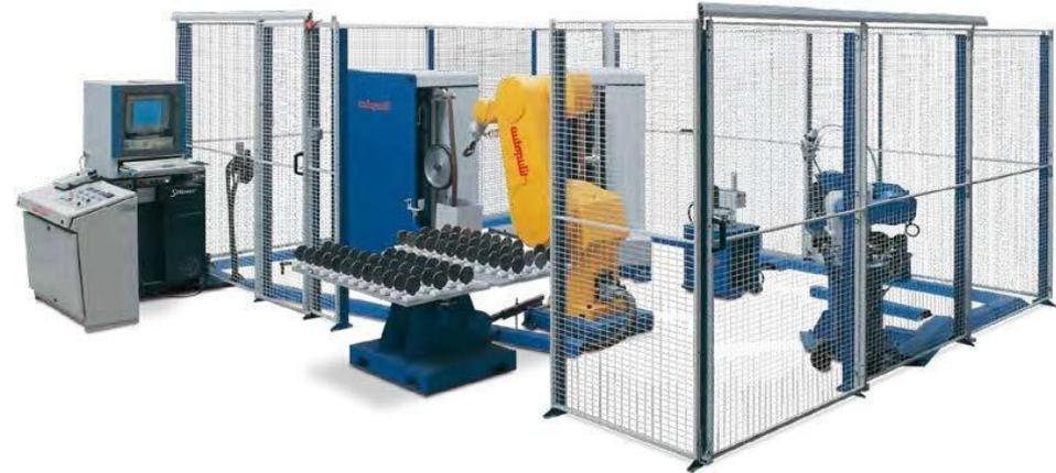
Заготовки перед подачей их роботом в зону обработки **предварительно ориентируются** и **подаются на фиксированную промежуточную позицию**, обслуживаемую автоматизированными загрузочно-разгрузочными устройствами типа тактового стола или шагового конвейера-накопителя
