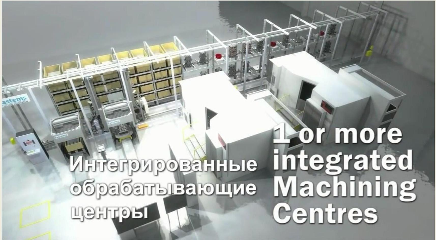
□ **автоматизированная транспортно-загрузочная система (АТЗС)** - система взаимосвязанных автоматизированных транспортно-загрузочных устройств (промышленные роботы , манипуляторы, автооператоры) для загрузки и выгрузки станков
