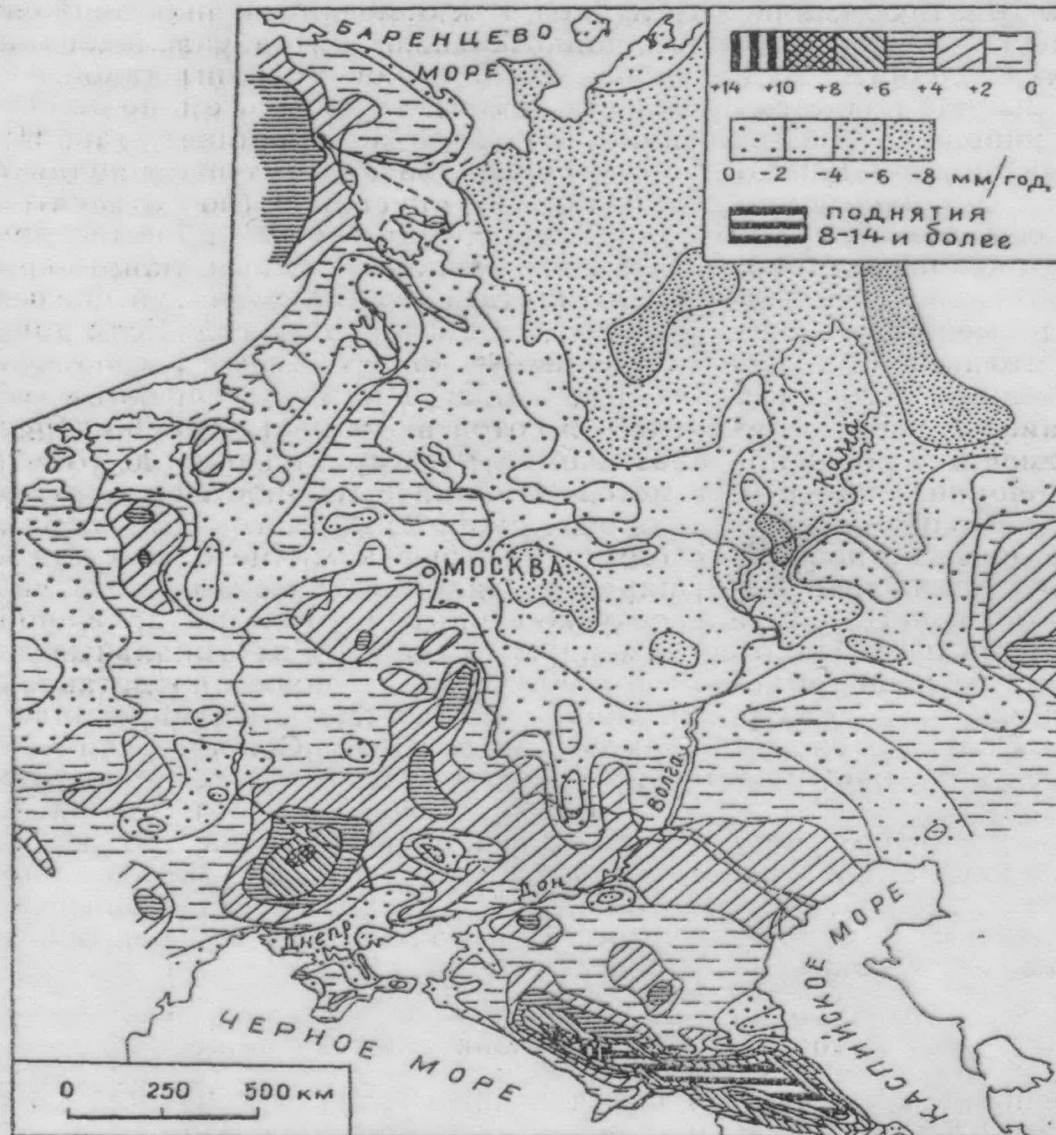
Рис. 4.1. Современные вертикальные движения в Восточной Европе по результатам повторных нивелировок. С карты под редакцией Ю. А. Мещерякова (1971), упрощено
