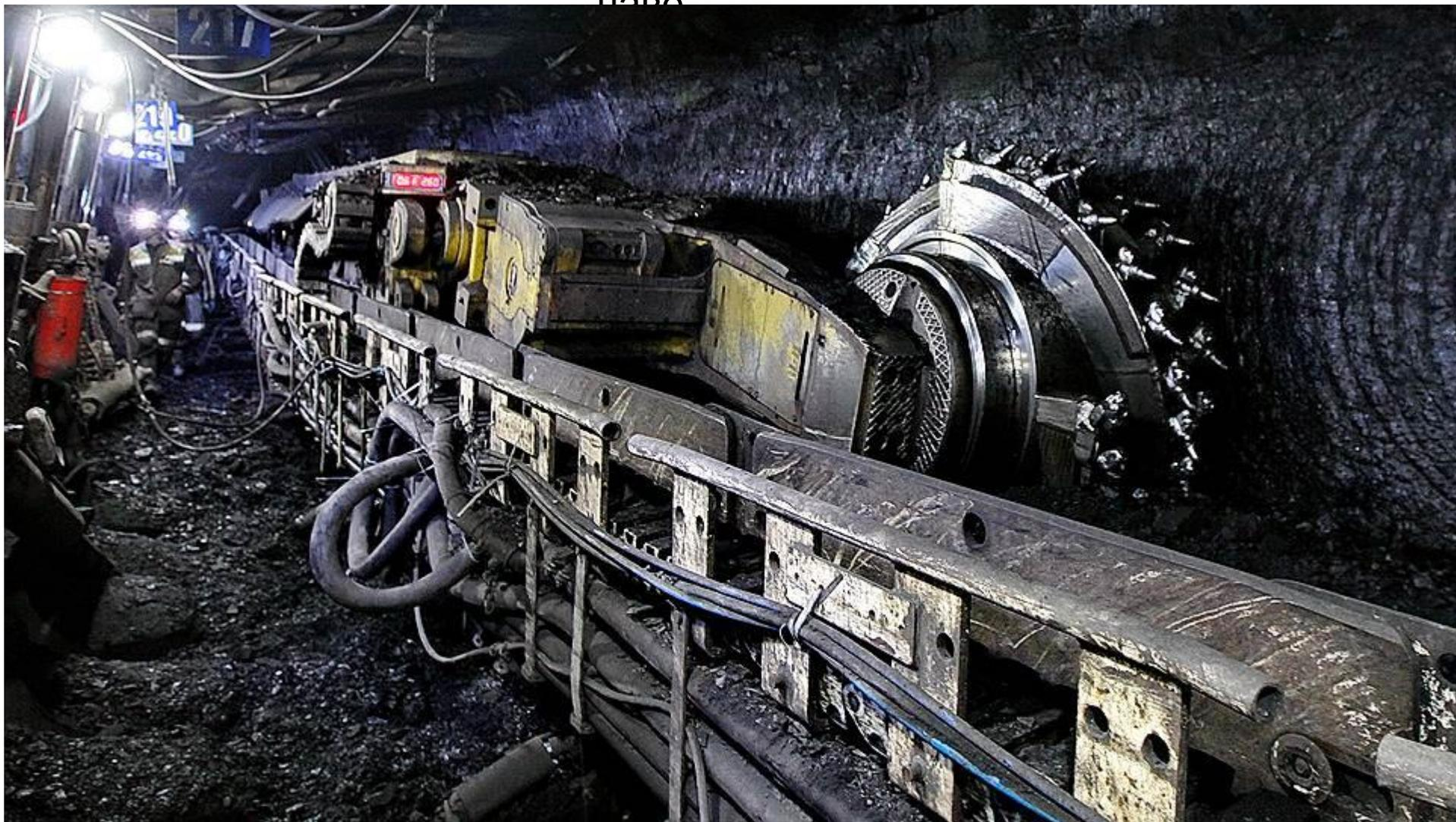
Комбайны с барабанным и шнековым исполнительными органами.
