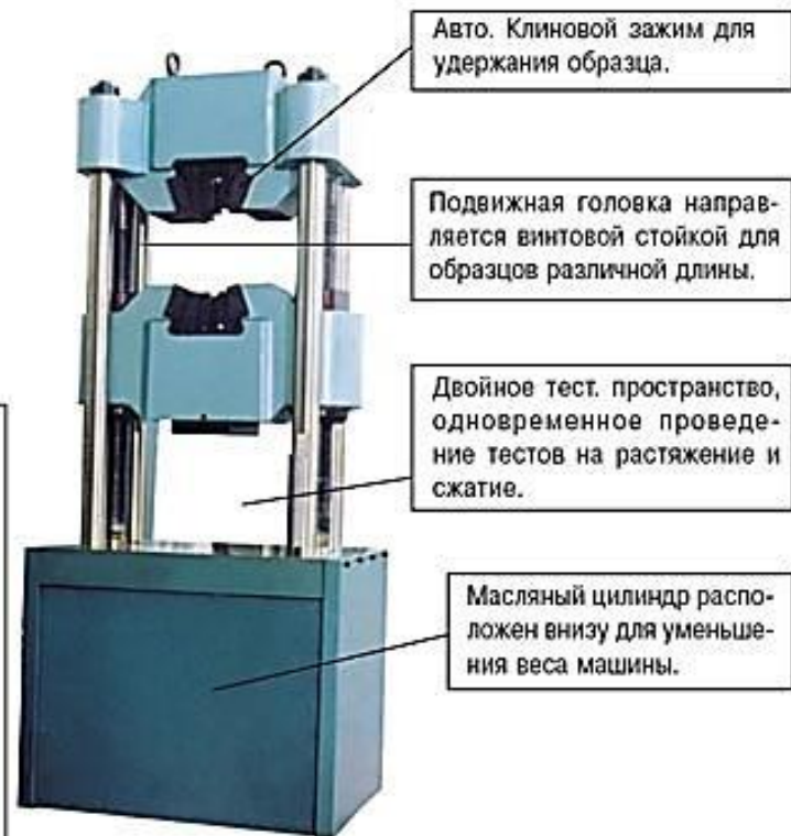
Универсальная испытательная машина с компьютерным отображением хода испытаний
