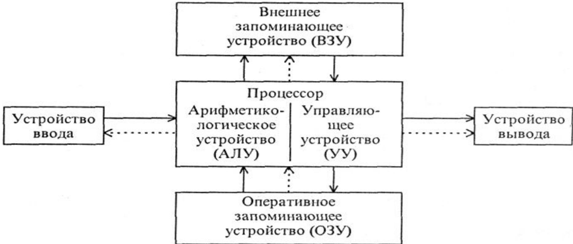
**Сплошные линии со стрелками указывают направление потоков информации, пунктирные - направление управляющих сигналов от процессора к остальными узлам ЭВМ**
