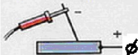
Рис. 2С Схема сварки на постоянном токе прямой полярности
