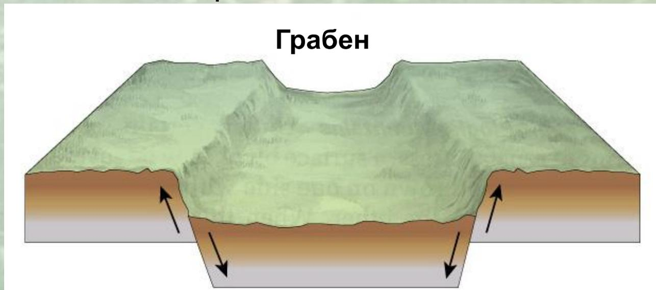
Грабен может быть образован как двумя сбросами в обстановке растяжения (а), так и двумя взбросами в обстановке относительного сжатия (б).
