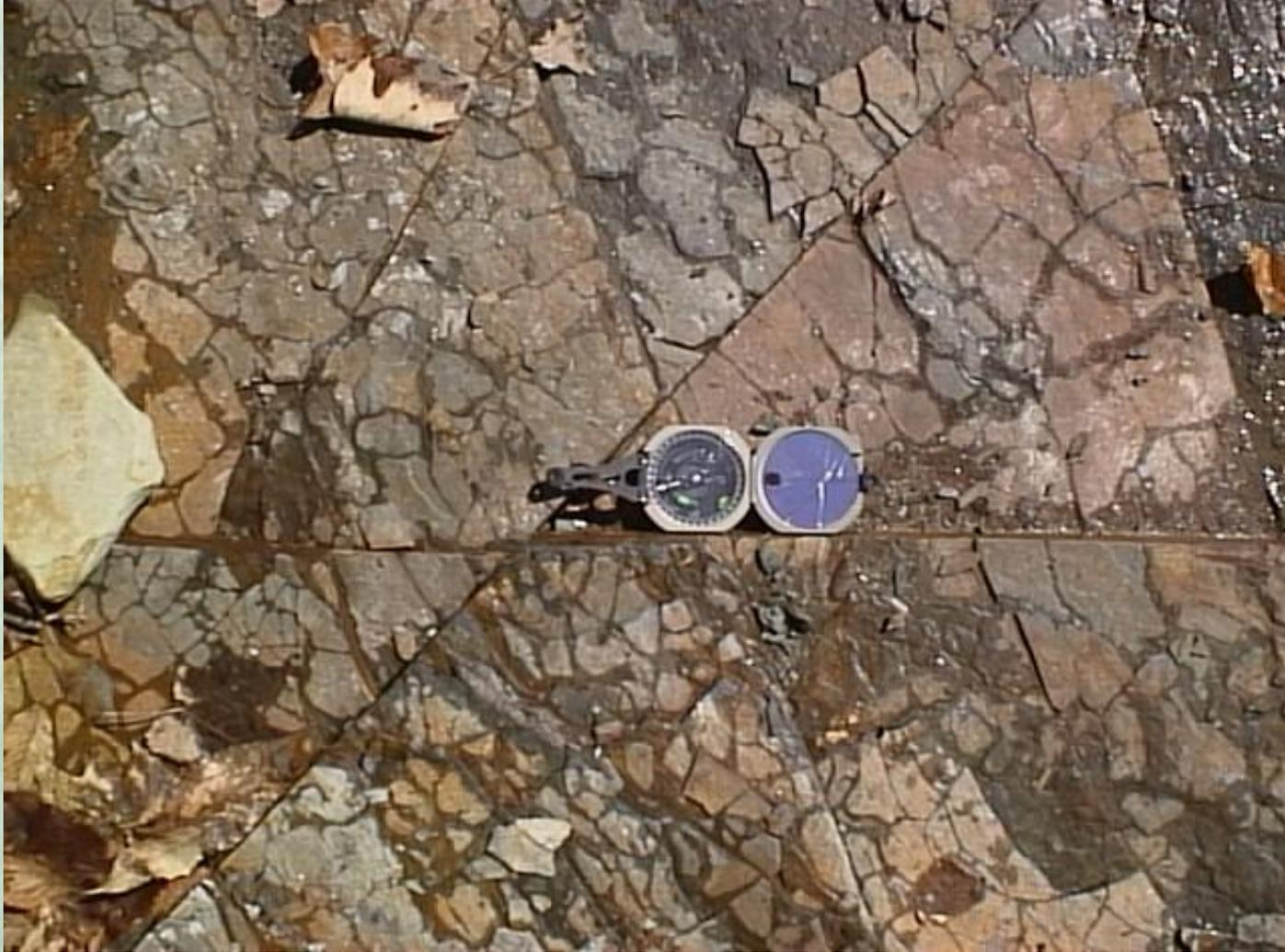
Часто трещины скалывания образуют сопряжённые системы, ориентирующиеся под углом, несколько меньшим  $45^\circ$  к направлению оси сжатия. Трещины обычно плотно сжаты и имеют гладкие поверхности.
