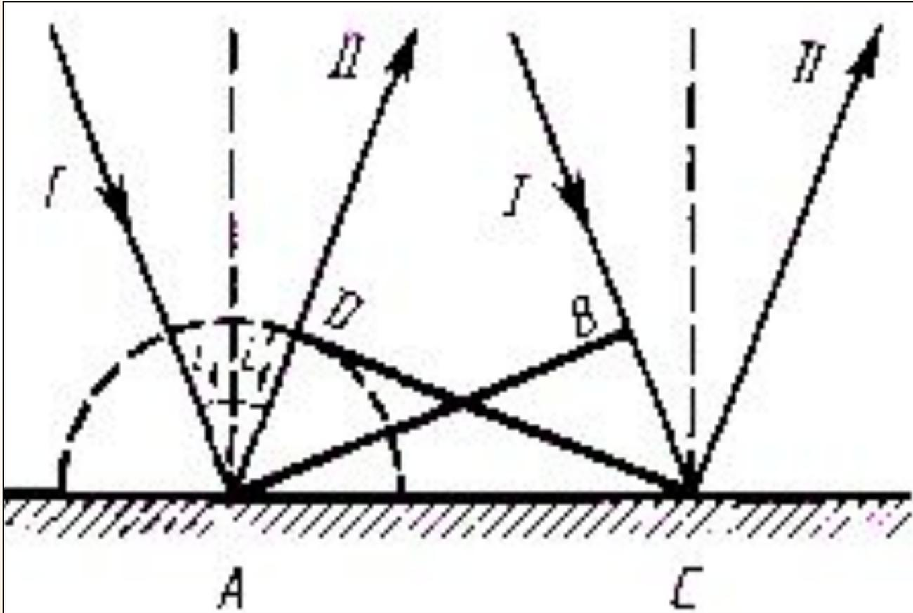
угол падения  $i_1$  равен углу отражения  $i'_1$ :  $i'_1 = i_1$ .
