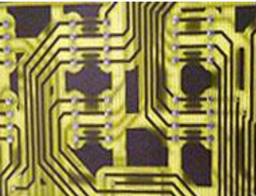
Изображенные на фотопленке элементы микросхемы проецируются на кристалл кремния, где получается подобное уменьшенное (с помощью системы линз) изображение микросхемы. Специальная обработка позволяет превратить это изображение в печатную микросхему
