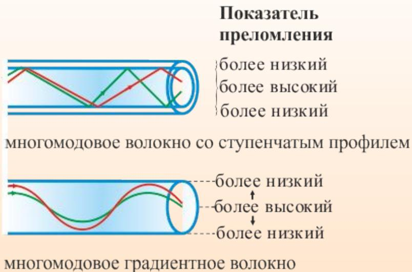
Таким образом, с помощью световодов можно как угодно искривлять путь светового пучка. За счет многократного полного отражения свет может быть направлен по любому прямому или изогнутому пути
