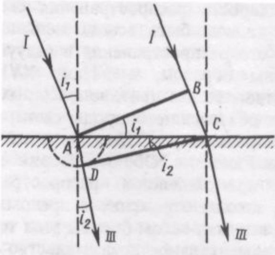
предположим, что плоская волна (фронт волны- $AB$ ), распространяющаяся в вакууме вдоль направления  $I$  со скоростью  $c$ , падает на границу раздела со средой, в которой скорость ее распространения равна  $v$ . Пусть время, затрачиваемое волной для прохождения пути  $BC$ , равно  $\Delta t$ .
