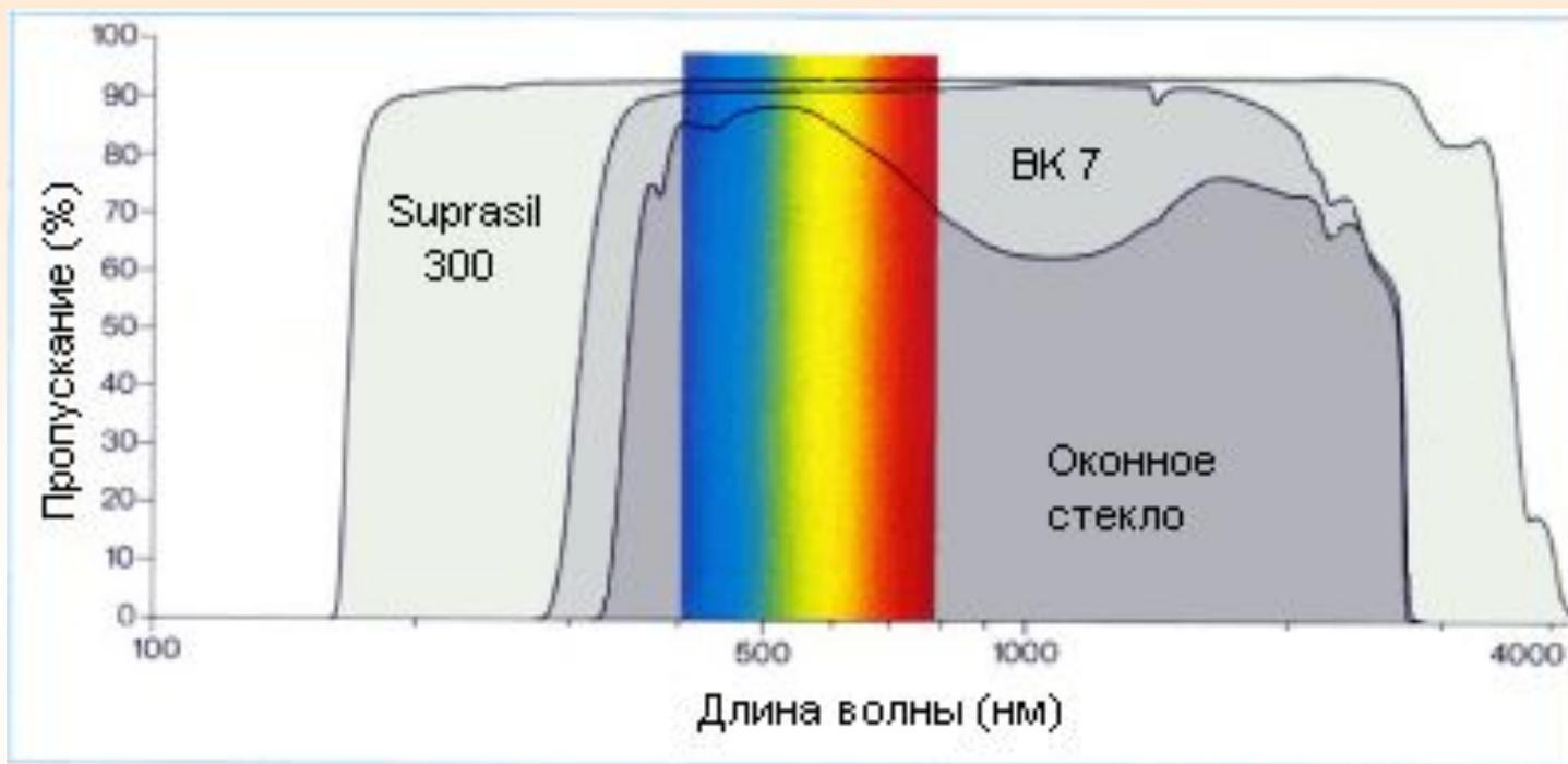
Спектр оптического пропускания синтетического кварцевого стекла Suprasil 300, оптического стекла ОК 7 и обычного стекла.
