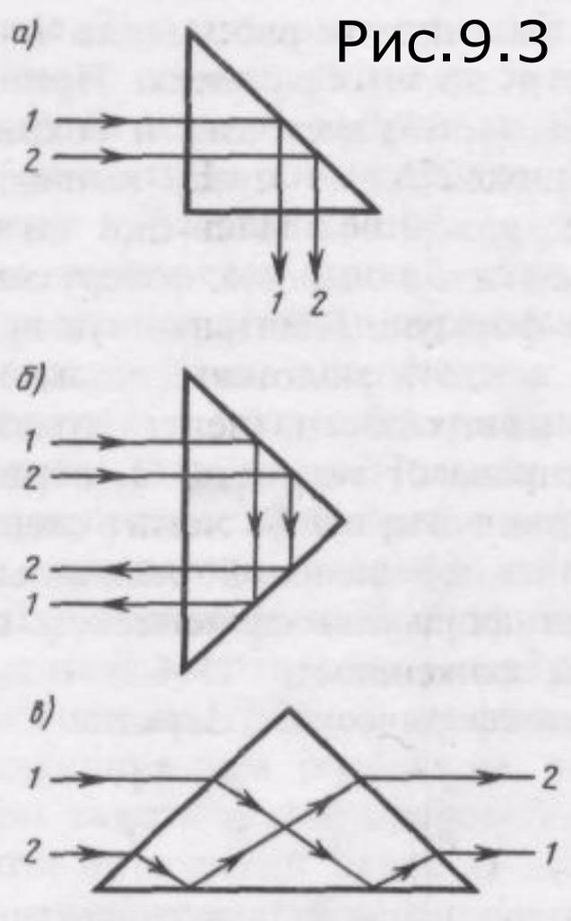
**Такие призмы применяются в оптических приборах** (например, в биноклях, перископах), а также в рефрактометрах, позволяющих определять показатели преломления тел (по закону преломления, измеряя  $i_{\text{пр}}$ , определяем относительный показатель преломления двух сред, а также абсолютный показатель преломления одной из сред, если показатель преломления второй среды известен.
