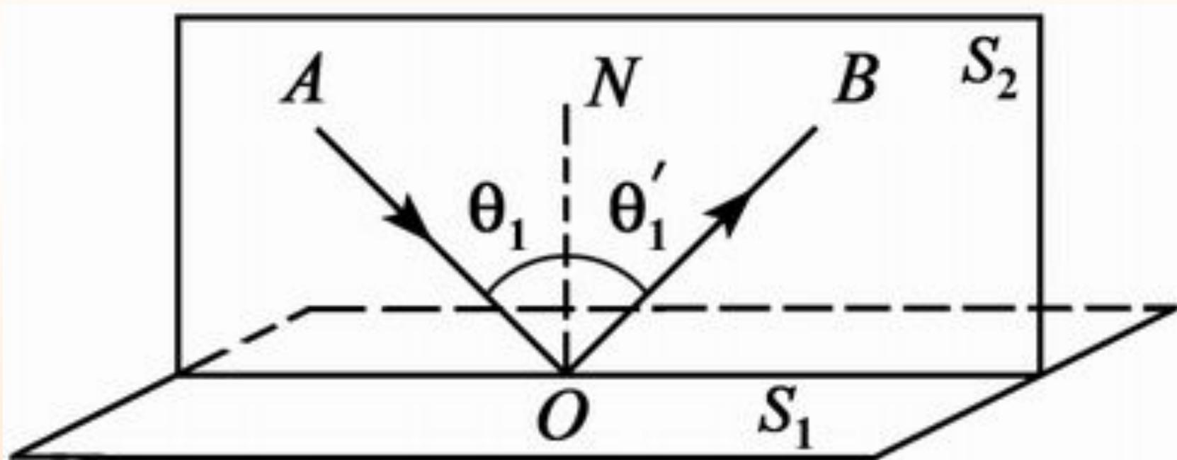
$S_1$  - отражающая поверхность;  $S_2$  - плоскость падения;  $AO$  - падающий луч;  $OB$  - отраженный луч;  $ON$  - нормаль к отражающей поверхности.
