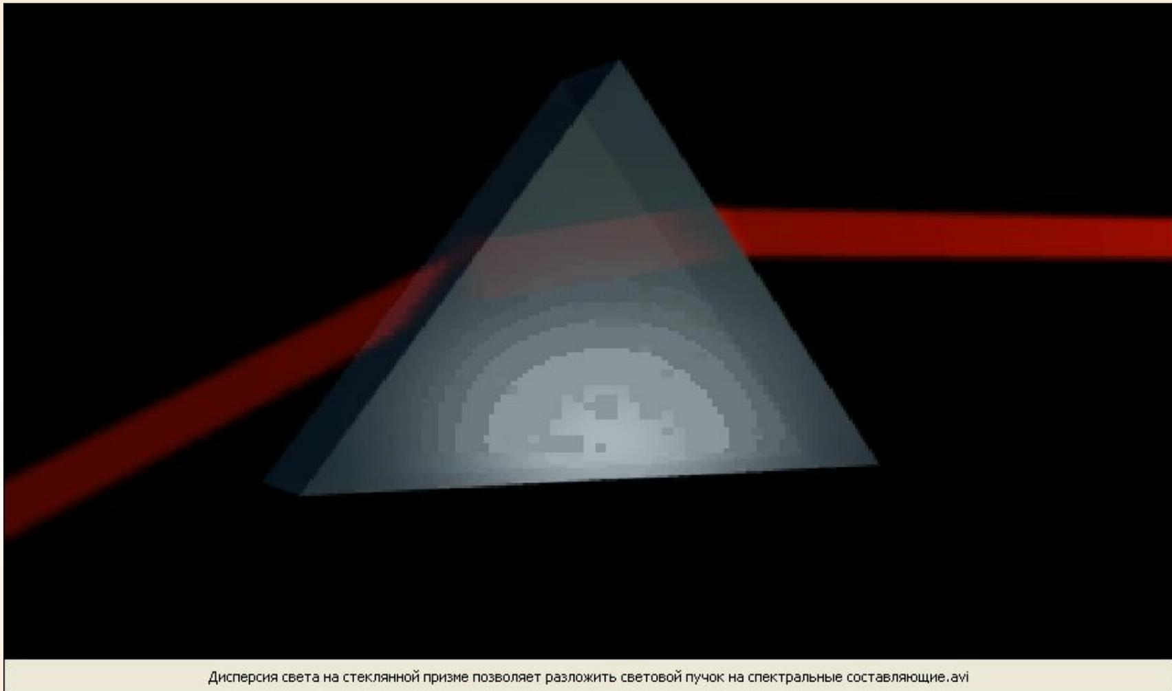
Дисперсия света на стеклянной призме позволяет разложить световой пучок на спектральные составляющие.avi
