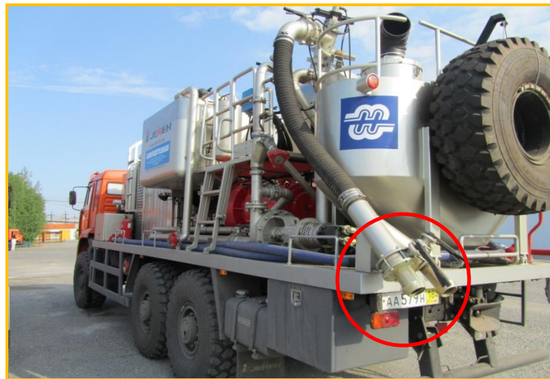
Установка насосная УНБ-600х50К с системой приготовления тампонажного раствора
