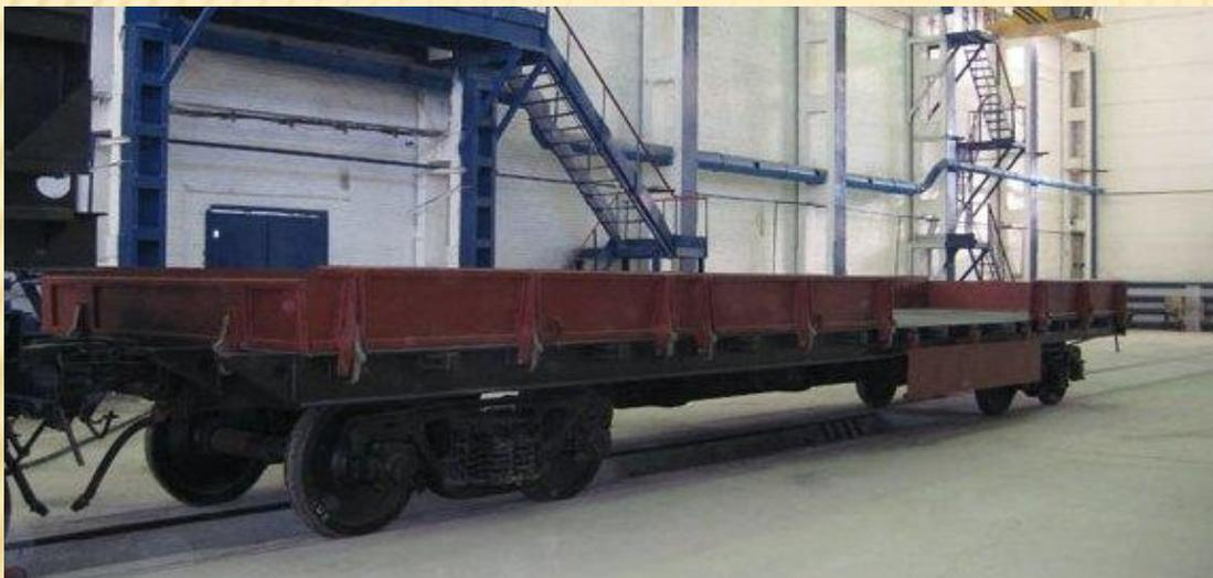
Настил пола платформы подкреплён дополнительными балками рамы. Торцевые борта в открытом положении служат проездыными мостками для погрузки колёсной техники автомобилем.
