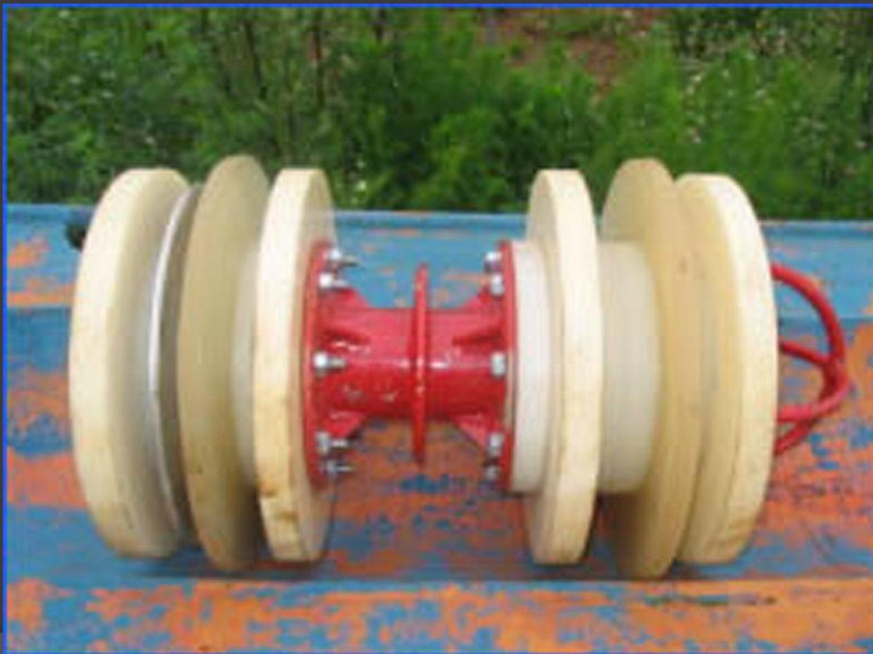
Очистные поршни с передатчиком для обнаружения поршня — трансмиттером.
