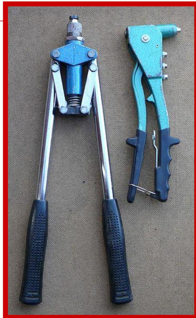
Бытовое устройство для установки заклёпок - «заклёпочник»
