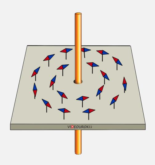
Линии магнитного поля прямого проводника с током представляют собой замкнутые концентрические окружности, центром которых является проводник с током.
