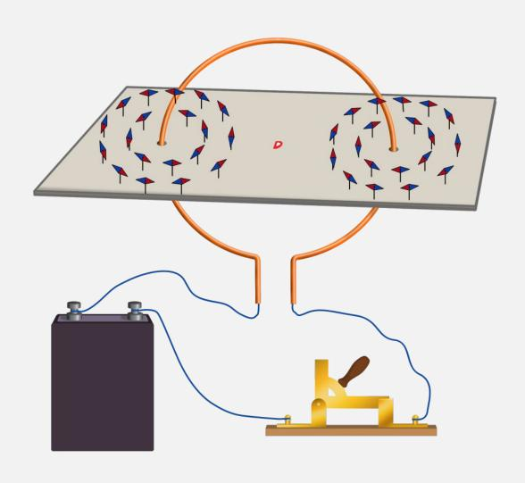
Линии магнитного поля прямого проводника с током представляют собой замкнутые концентрические окружности, центром которых является проводник с током.
