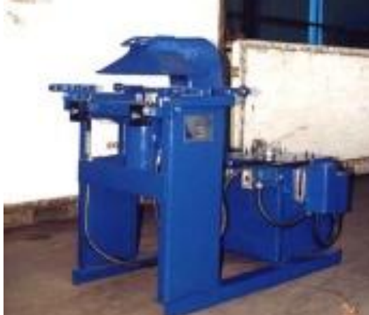
Стационарный пресс-скоба для запрессовки МЗП.
