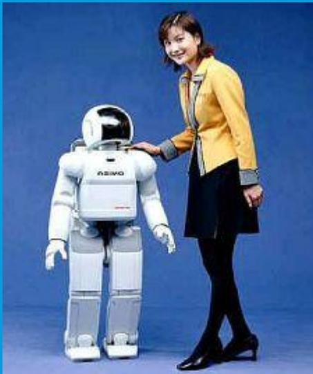
Honda представляет Asimo - следующее поколение своего ряда гуманоидных роботов. Робот Asimo меньше по размеру, но проворен, чем его предшественники. Он весит 43 кг при росте 120 см. По мнению разработчиков, комплектация Asimo идеальна для перемещения по дому, открывания дверей и выполнения таких работ, как протирка стола и стульев.
