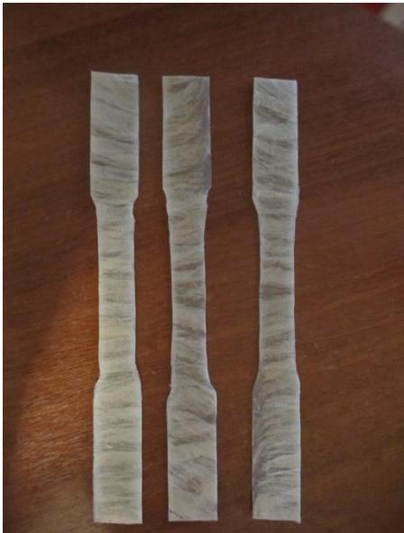
Образцы для испытаний на растяжение
