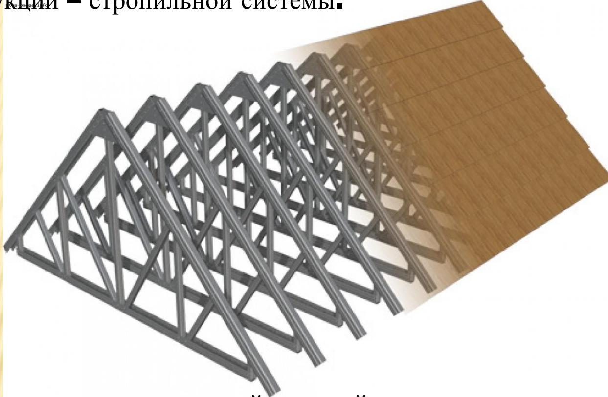
Стропила являются основной несущей частью конструкции крыши.
