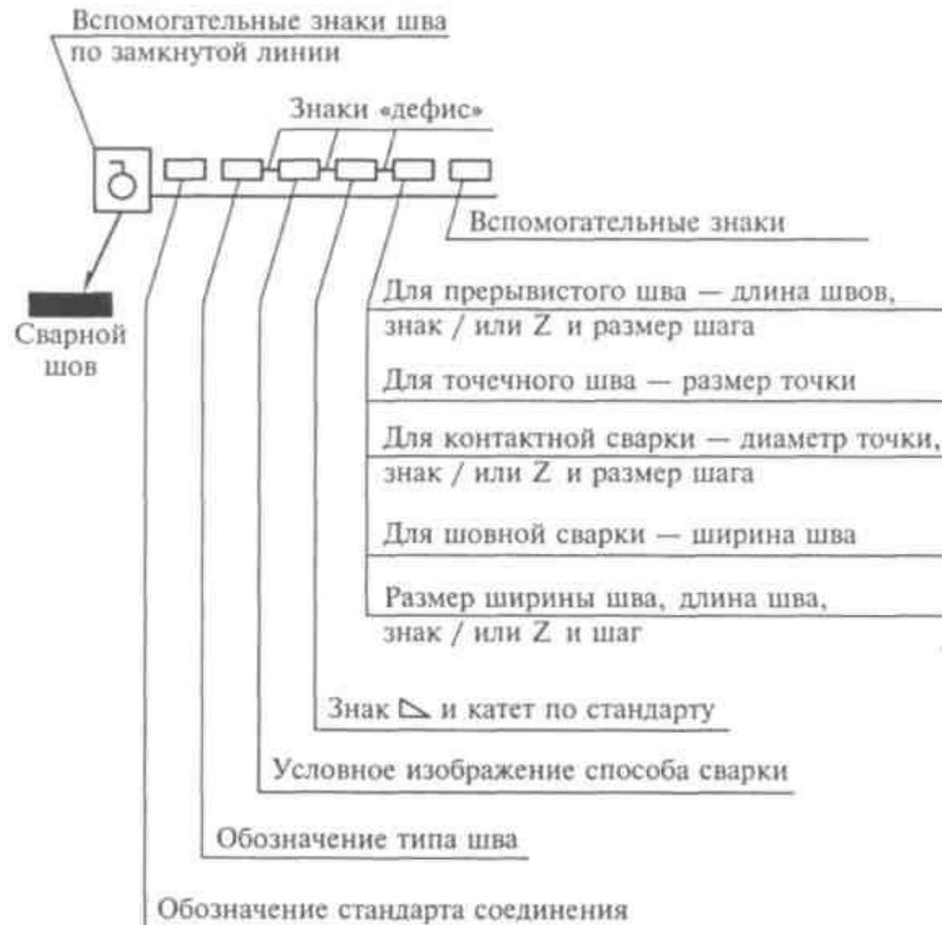
**Примеры условных обозначений швов сварных соединений**
