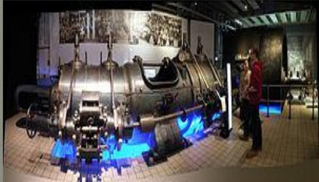
Первая паровая машина построена в XVII в. Папеном и представляла цилиндр с поршнем, который поднимался действием пара, а опускался давлением атмосферы после сгущения отработавшего пара. На этом же принципе были построены в 1705 году паровые машины Севери и Ньюкомена
