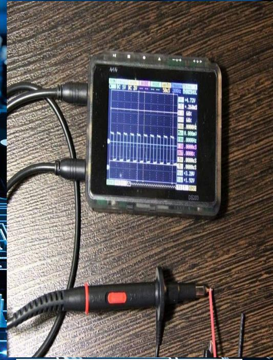
Осциллограф - Прибор, предназначенный для исследования амплитудных и временных параметров электрического сигнала
