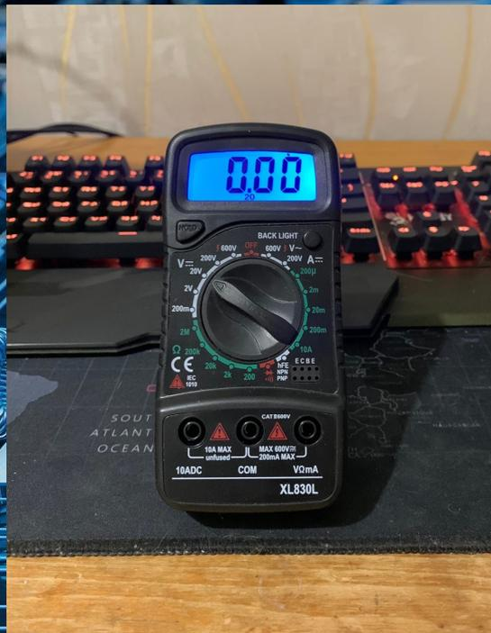
Мультиметр - для измерения сопротивления и напряжения в электрической цепи
