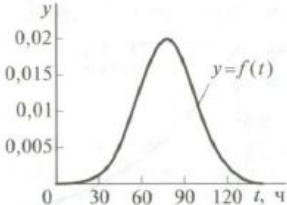
Рис. 3.4. График плотности нормального распределения с параметрами  $m = 80$  ч.,  $\sigma = 20$  ч.
