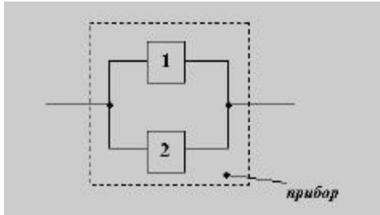
Прибор состоит из 2-х блоков, дублирующих друг друга. Вероятность того, что за время  $T$  каждый из блоков проработает безотказно, равна 0.9. Отказ прибора произойдет при отказе обоих блоков. Найти вероятность того, что за время  $T$  прибор проработает безотказно?
