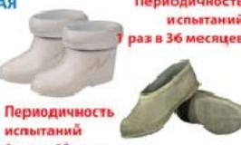
Диэлектрическая обувь защищает работающих от напряжения шага. В электроустановках применяются диэлектрические боты и галоши. Галоши применяют в электроустановках напряжением до 1000 В, боты - при всех напряжениях.
