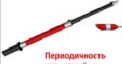
Указатели напряжения предназначены для определения наличия или отсутствия напряжения на токоведущих частях электроустановок. Указатели напряжения выше 1000 В реагируют на емкостной ток, протекающий через указатель при внесении его рабочей части в электрическое поле, образующее токоведущими частями электроустановок, находящимися под напряжением, и "землей" и заземлениями конструктивных электроустановок.
