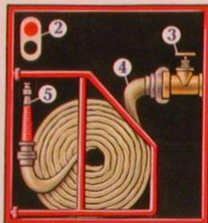
ПРЕДНАЗНАЧЕН для тушения пожаров и загораний веществ и материалов, кроме электроустановок под напряжением
