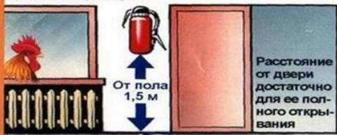
В общественных зданиях и сооружениях расстояние до места возможного возгорания должно быть не более 20 м
