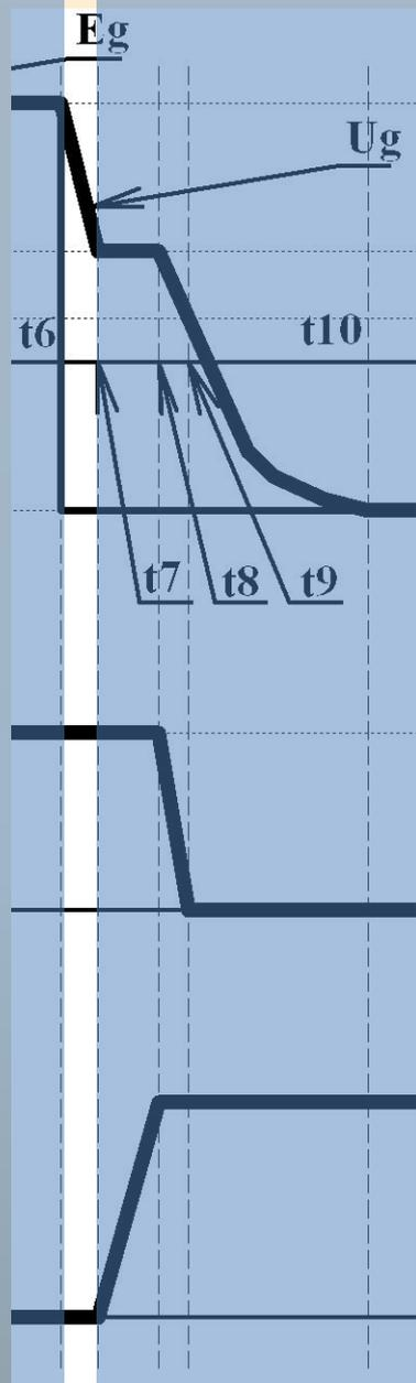
$$U_g(t) = U_{g+} \cdot e^{-\frac{t-t_6}{\tau}} + U_{g-} \cdot \left(1 - e^{-\frac{t-t_6}{\tau}}\right) = (U_{g+} - U_{g-}) \cdot e^{-\frac{t-t_6}{\tau}} + U_{g-}$$
