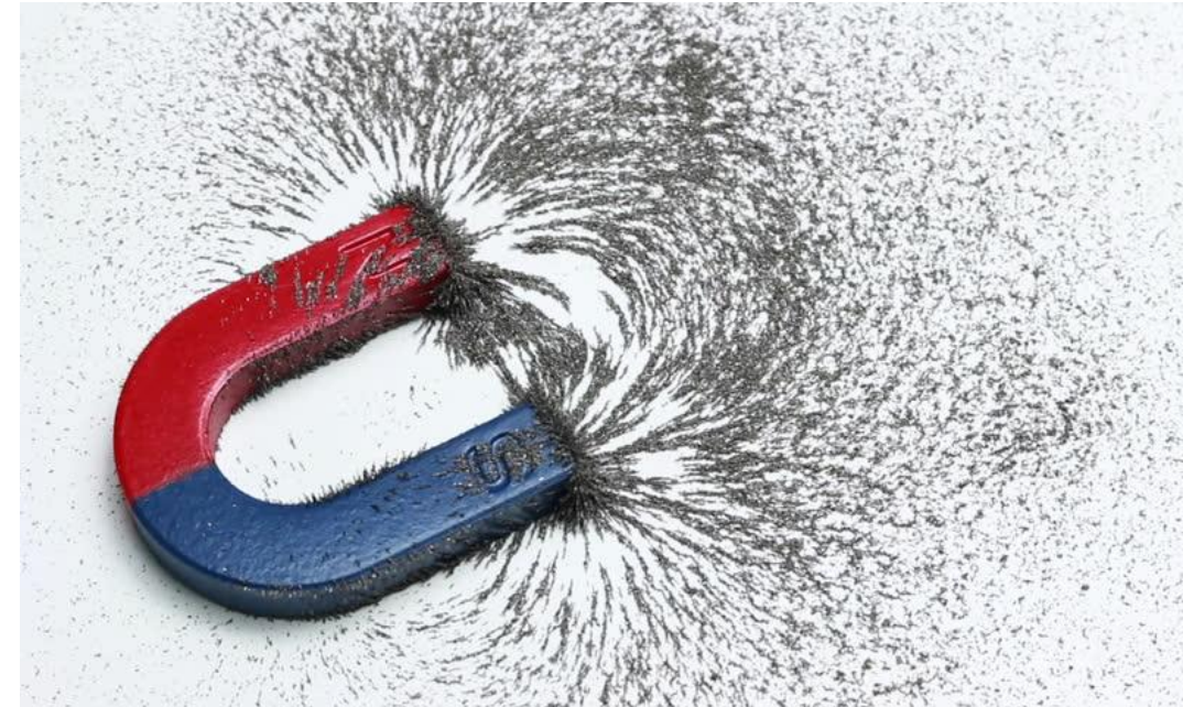
Вид линий магнитного поля дугового магнита
