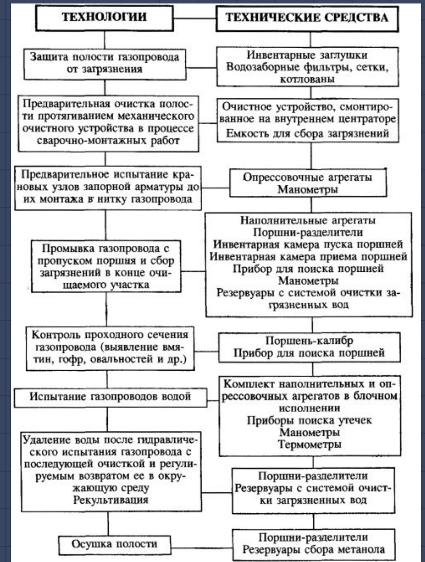
Технологии и технические средства по очистке полости и испытанию газопроводов гидравлическим способом
