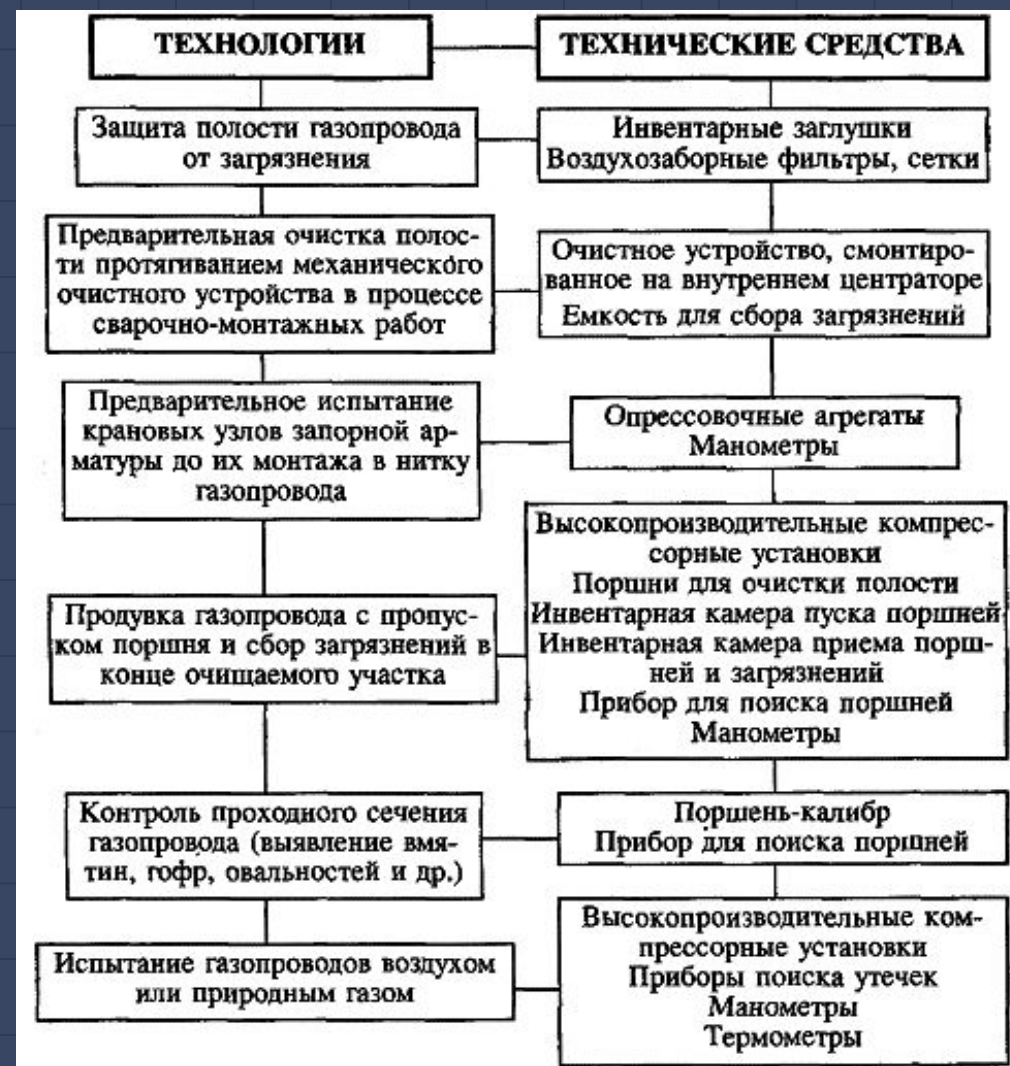
Технологии и технические средства по очистке полости и испытанию газопроводов пневматическим способом
