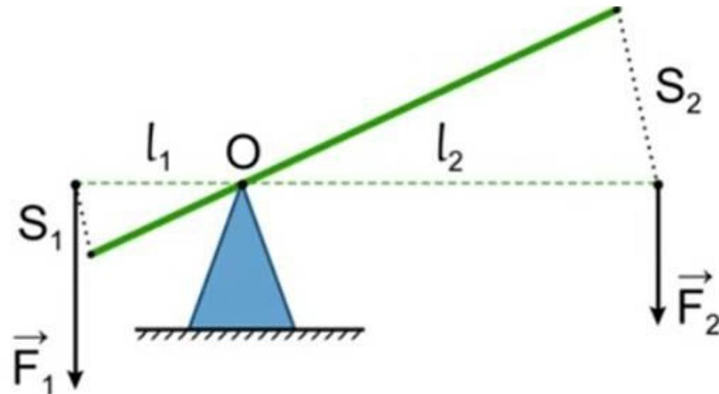
При использовании рычага выигрыша в работе не получают. Пути, пройденные точками приложения сил на рычаге, обратно пропорциональны силам:
