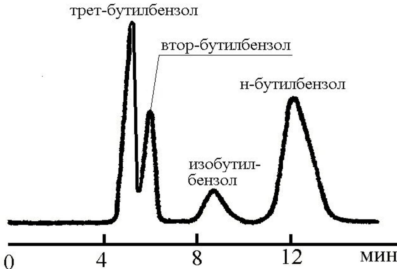
Хроматограмма разделения изомерных бутилбензолов на насадочной колонке с 100 x 0,5 см с карбопаком С
