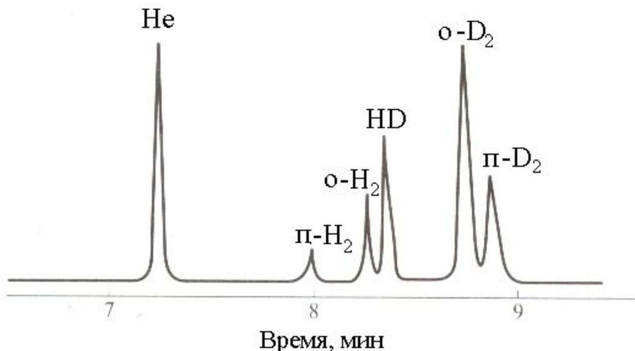
Газохроматографическое разделение ядерно-спиновых изомеров и изотопов водорода на капиллярной колонке 80 м x 0,25 мм из травленного стекла. Температура 77 К.
