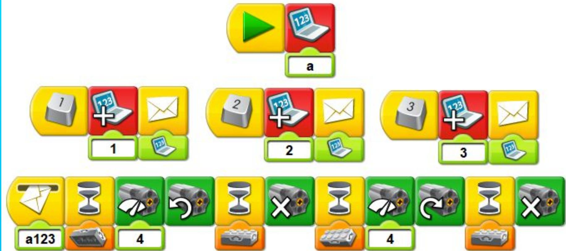
В программе, состоящей из 5 частей, в первых четырех частях в определенном порядке набраны буквы и числа из которых в пятой части программы составлен специальный код. В данном случае – а312. Включив программу нажатием блока «Начло» мы вводим этот код в блок «Начать при получении письма». И только тогда наша волшебная шкатулка откроется .
