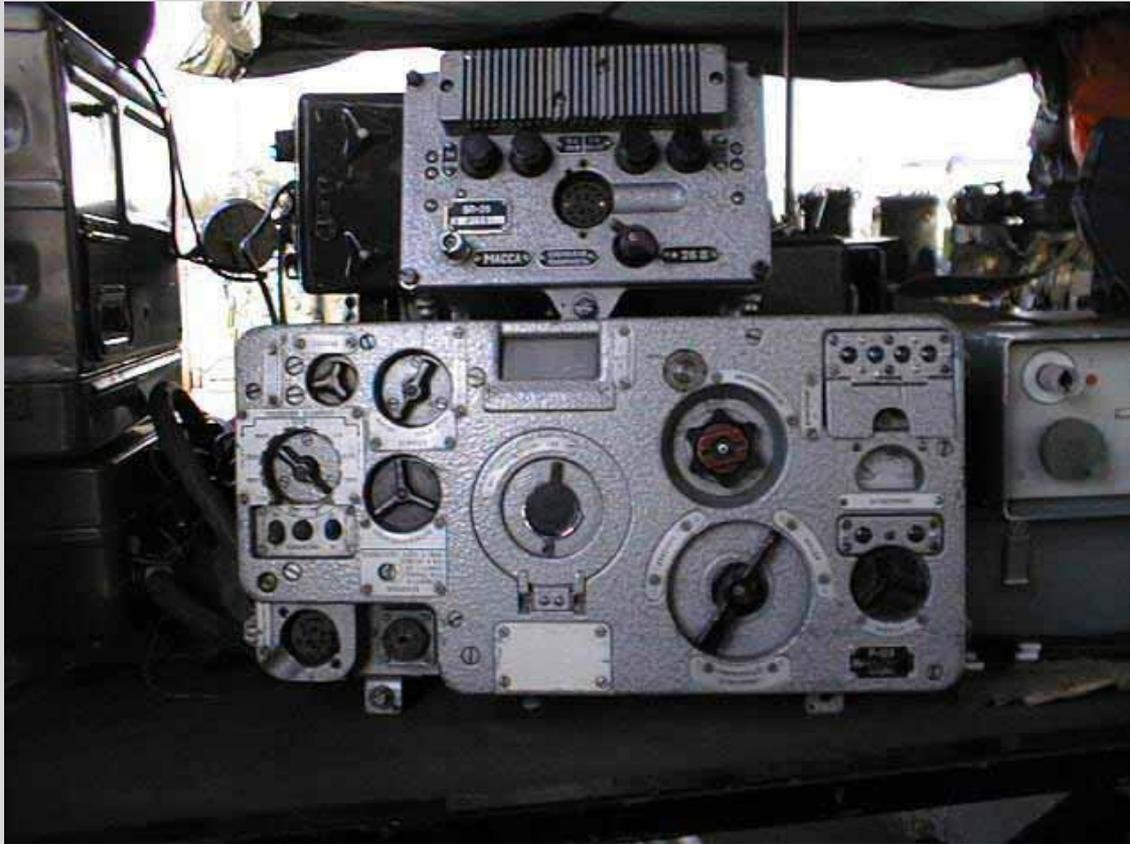
Рис.8 бортовая радиостанции Р-123М
