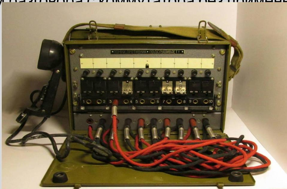
Рис.2 Полевой телефон индукторный коммутатор П-193 М
