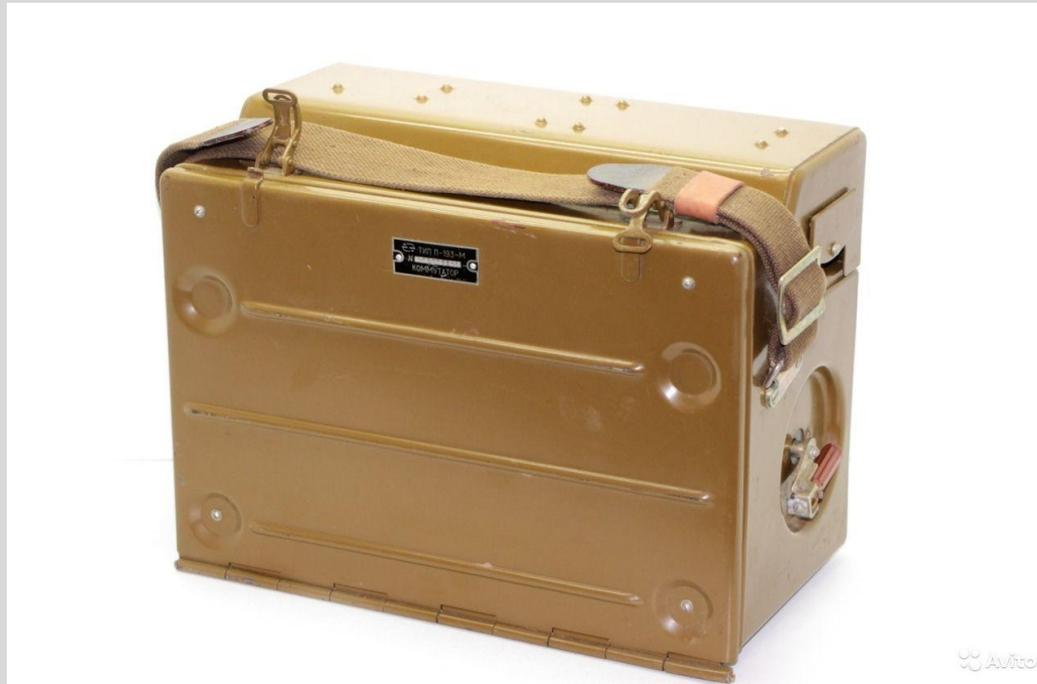
**Рис.1 Полевой телефонный индукторный коммутатор П-193 М**
