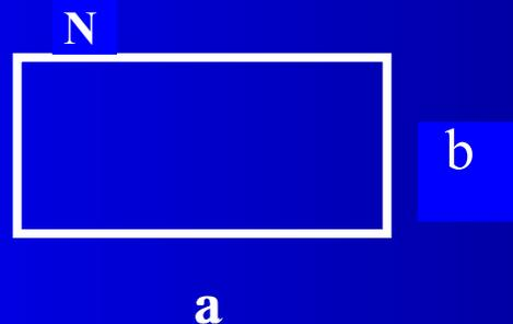
**Процесс** - для отображения операций по обработке данных (присваивание переменной численного значения, значения другой переменной или значения вычисленного выражения)
