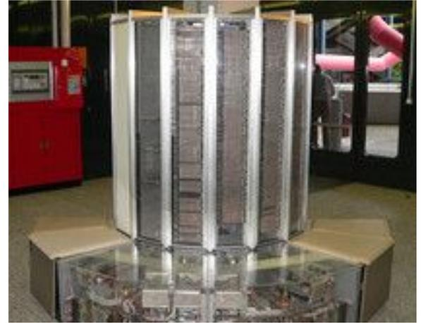
В суперкомпьютерах используется мультипроцессорный (многопроцессорный) принцип обработки информации или конвейерный.
