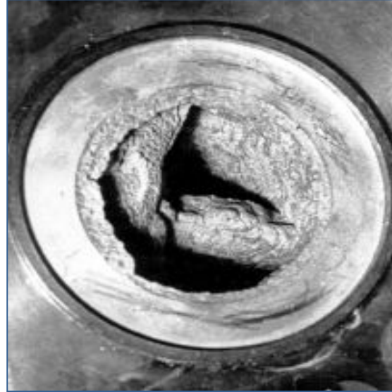
Отложения шлаков в контуре при испытаниях ГЦН в МОЦКТИ
