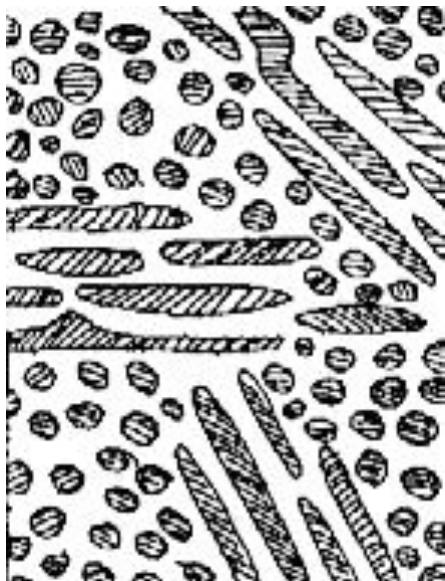
Мікроструктура евтектичного білого чавуну (схемне зображ.)
