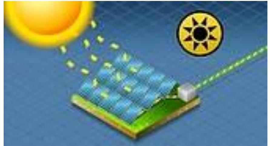
**Принцип работы батареи – это преобразование солнечной энергии в электрическую. Основана работа батареи на фотоэлектрическом эффекте. В результате воздействия светом на фотоэлемент батареи, преобразуется в энергии. В специальных аккумуляторах.**
