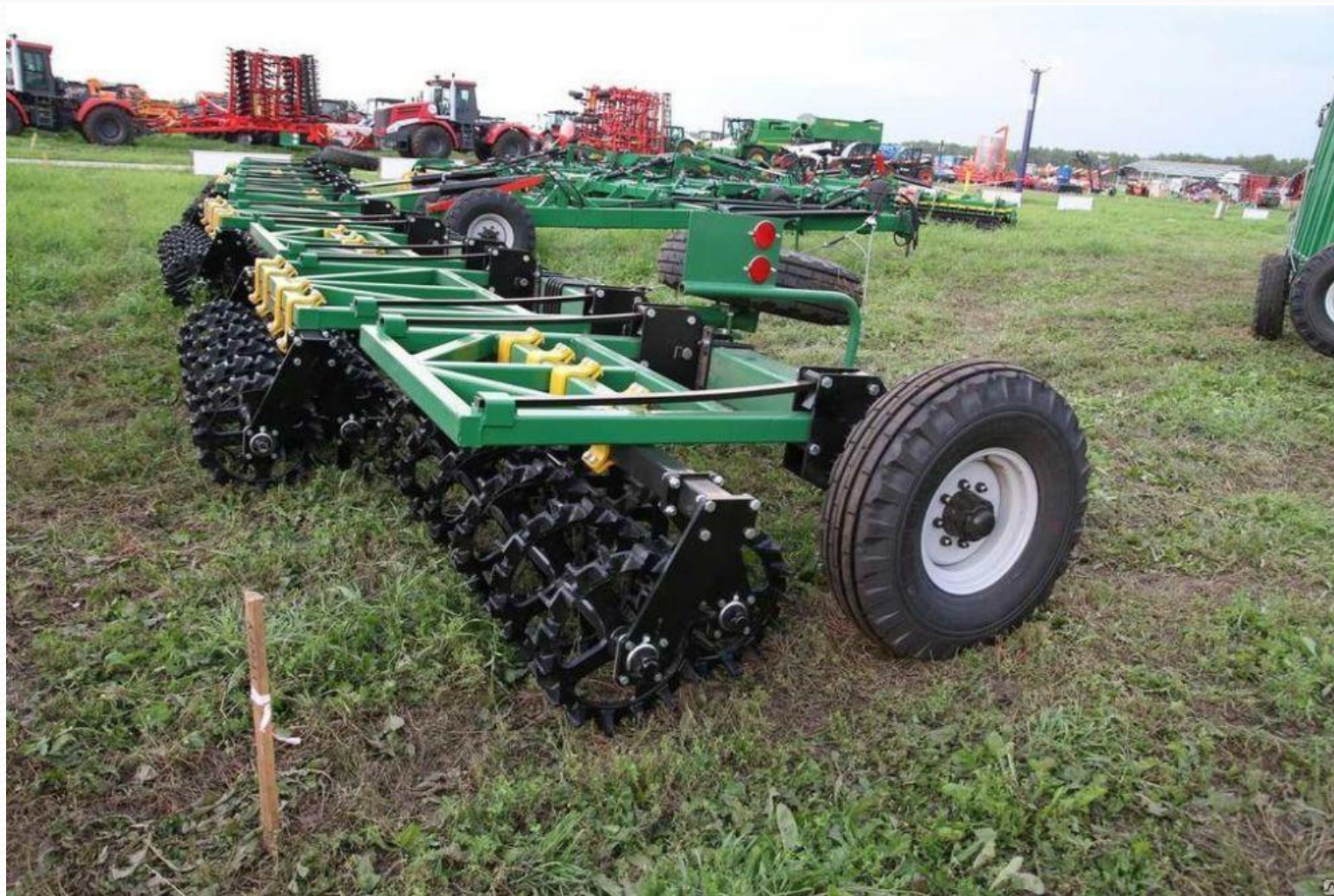
Каток прикатывающий кольчато-шпоровый АПУ-6,6-2КШ
