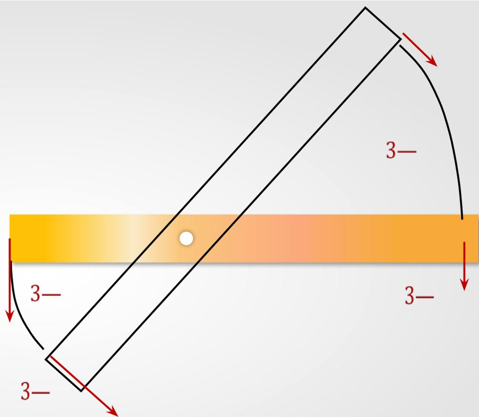
Выигрывая в силе, во столько же раз проигрываем в расстоянии.
