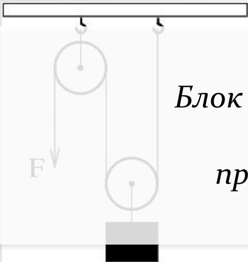
*Блок — устройство, в форме колеса с желобом, по которому пропускают веревку или трос.*
