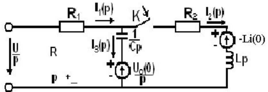
При составлении эквивалентных операторных схем источники тока и напряжений  $i(t)$  и  $U(t)$  заменяются соответствующими изображениями  $I(p)$  и  $U(p)$ , индуктивность  $L$  заменяется на  $Lp$ , а емкость  $C$  – на  $1/Cp$  при нулевых начальных условиях. Если начальные условия ненулевые, то последовательно с  $Lp$  добавляется источник напряжения  $Li(0)$ , а с  $C$  – источник напряжения  $-U_C(0)p$
