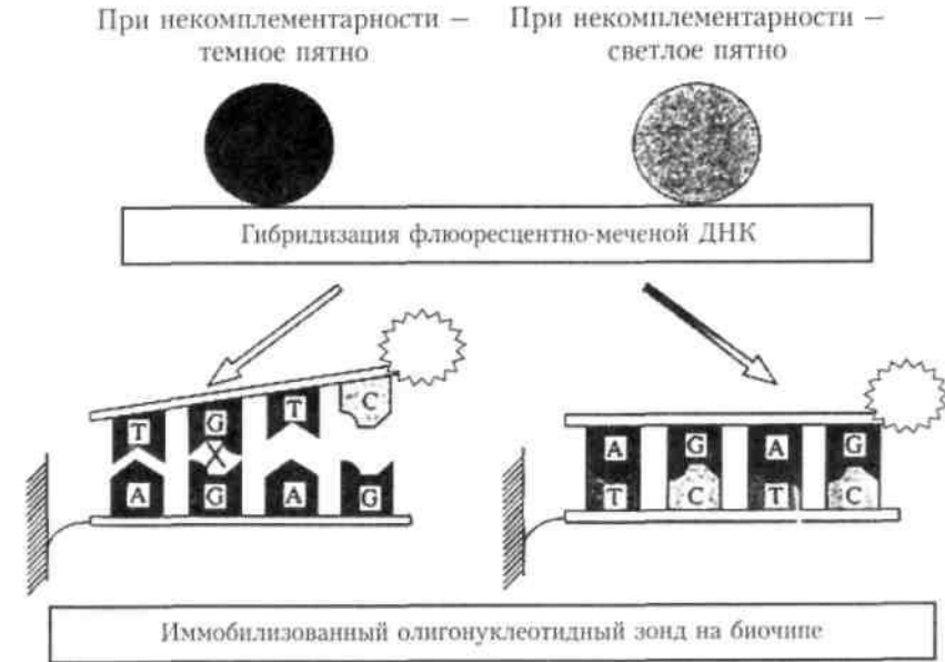
Рис. 1.7. Схема образования двойной спирали ДНК на биочипе (по данным А.Д. Мирзабекова, 2003)
