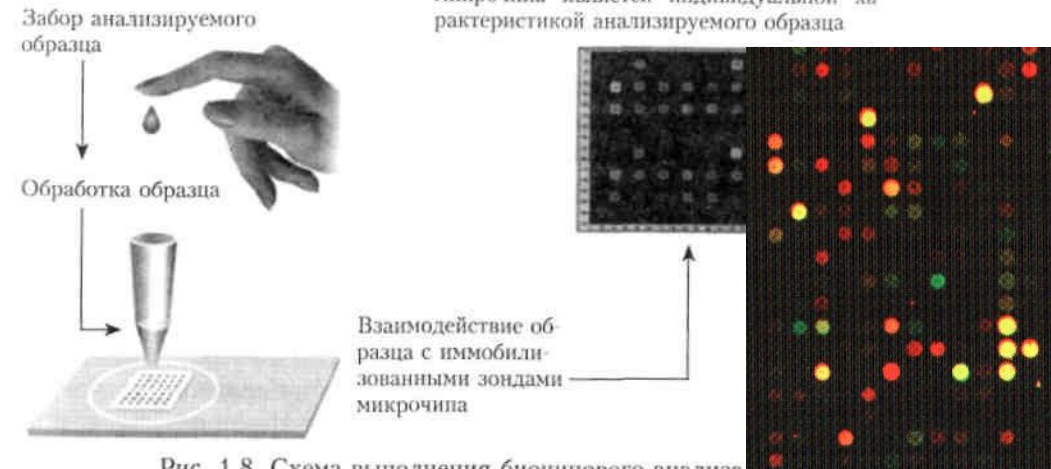
Рис. 1.8. Схема выполнения биочипового анализа (по данным О. Чаплина, 2005)
