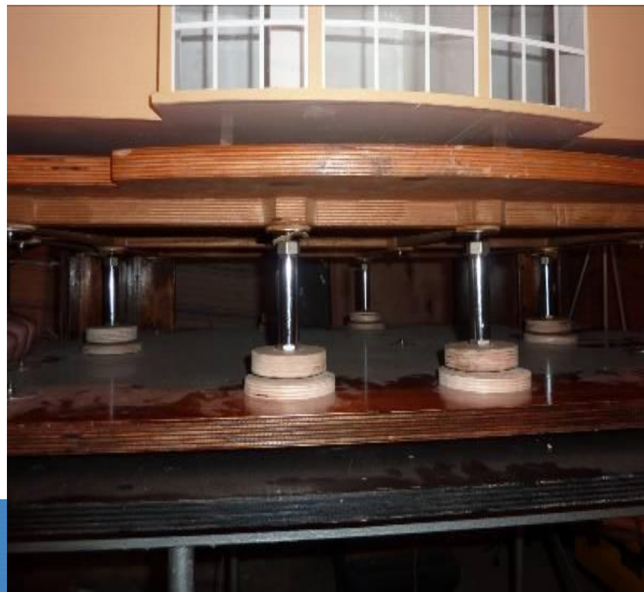
Положение сейсмоизолирующих опор модели здания в состоянии покоя (перед началом испытаний)
