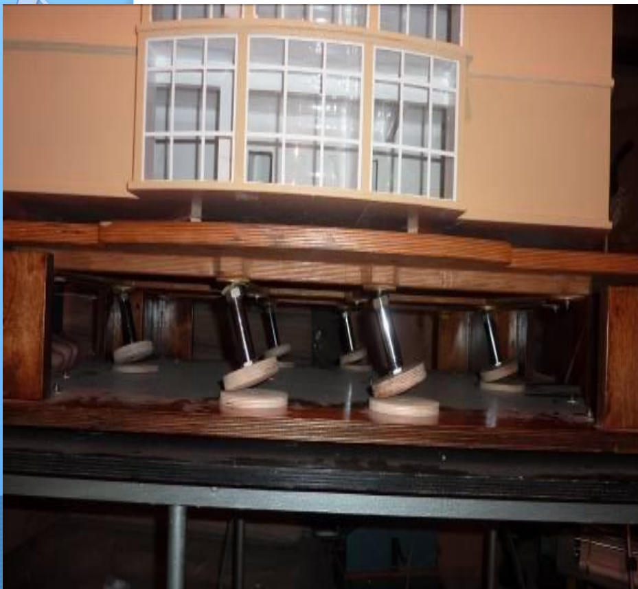
Положение сейсмоизолирующих опор модели при смещениях основания, соответствующих 9-ти балльным воздействиям
